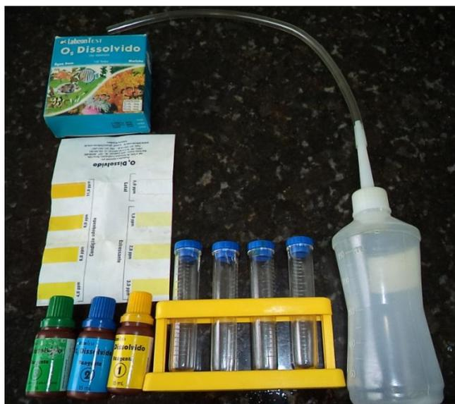
Foto 04: Kit para medição do nível de oxigenação da água
