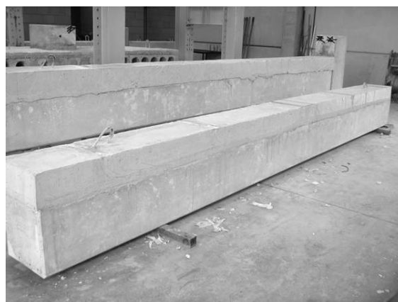
Figura 3-6: Vigas após concretagem de suas camadas superiores.
