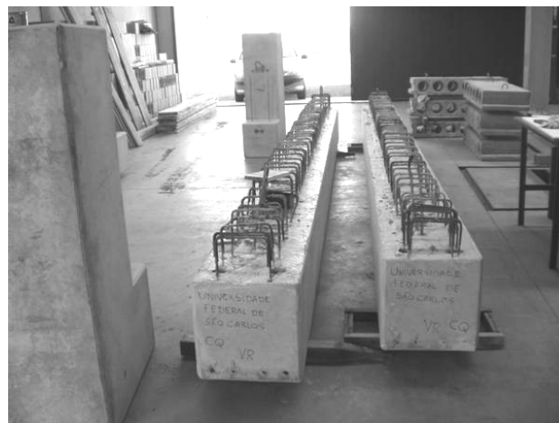
Figura 3-5: Pré-vigas fabricadas pela empresa Leonardi.
