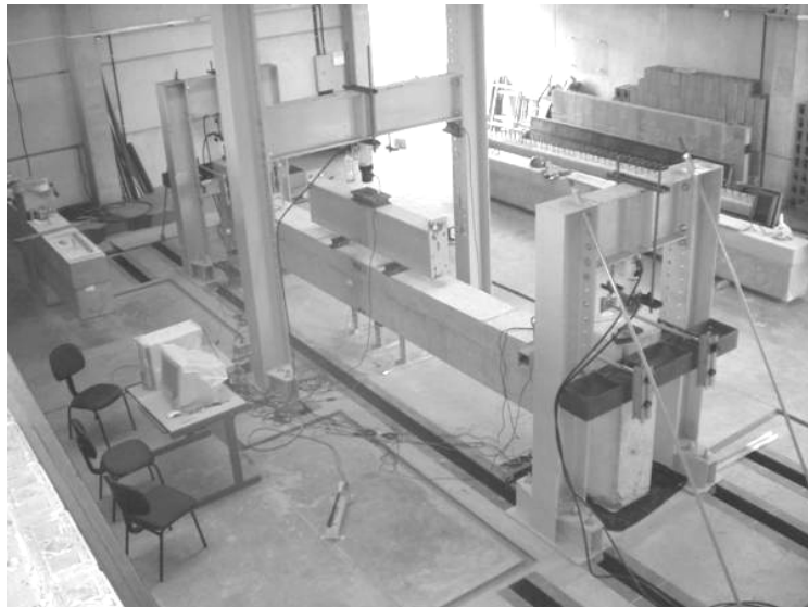
Figura 3-43: Instrumentação do modelo SR (composto por uma viga com ligações semi-rígidas).
