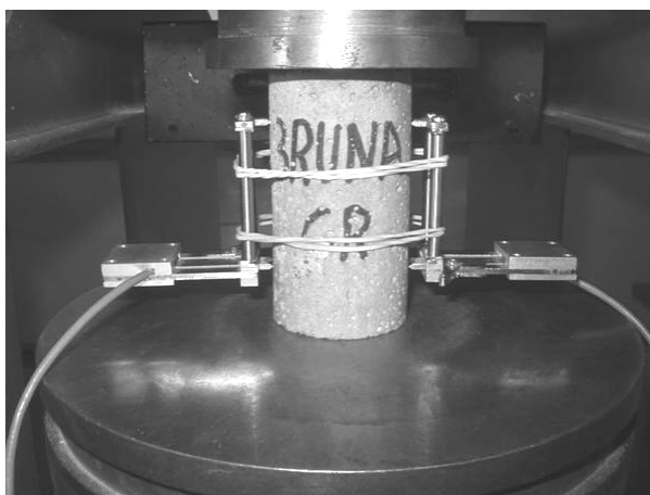
Figura 3-16: Ensaio para a determinação do módulo de elasticidade do graute empregado.
