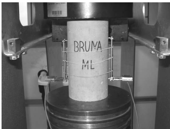
Figura 3-14: Ensaio para determinação do módulo de elasticidade do concreto moldado no local.
