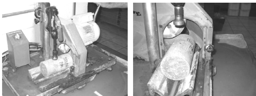
Figura 3-10: Faceador para corpo-de-prova utilizado para a etapa de retificação.
