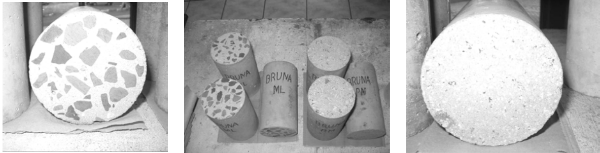
Figura 3-11: Corpos-de-prova após o processo de retificação.
