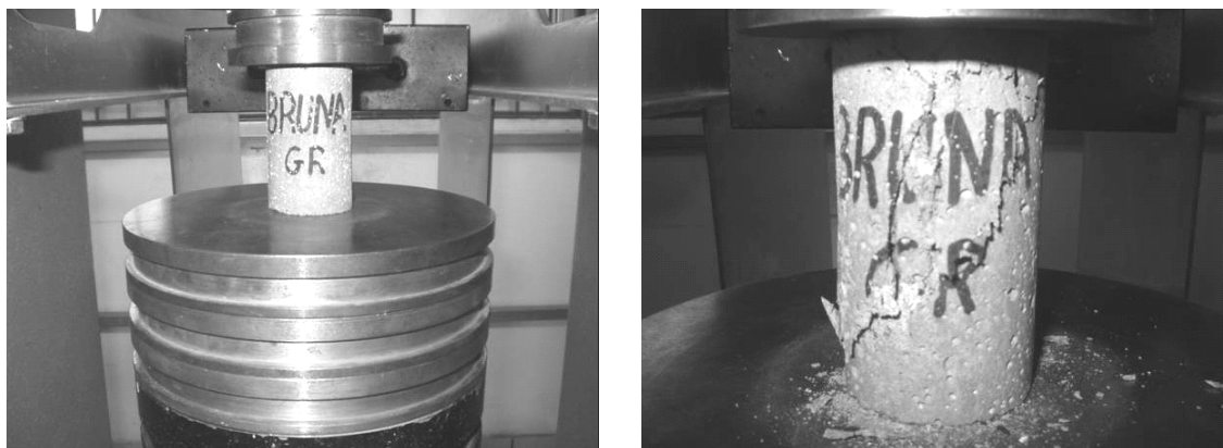
Figura 3-15: Ensaio de compressão axial simples em corpo-de-prova composto pelo graute utilizado.
