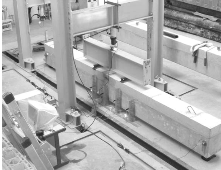
Figura 3-38: Instrumentação do modelo BA (composto por uma viga bi-apoiada)
