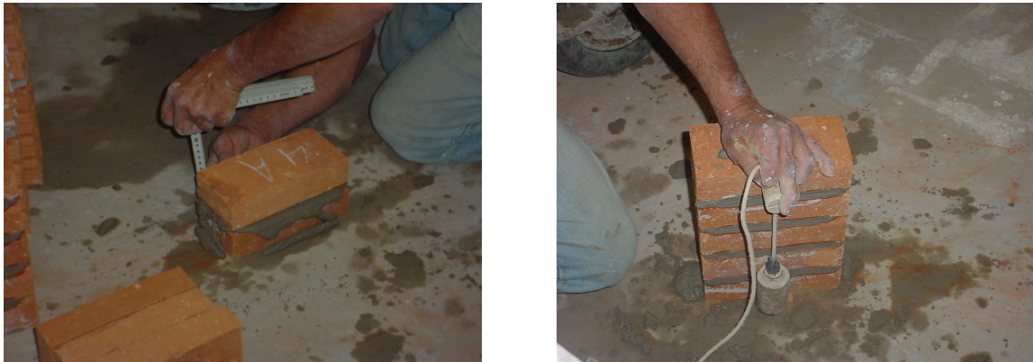
Foto 4.6 – Verificação da espessura da junta e do prumo dos corpos de prova
