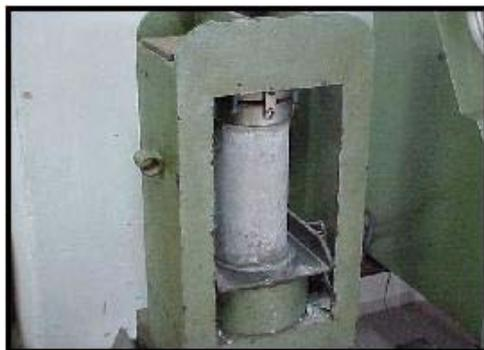
**FOTOGRAFIA 5.4 - ensaio de compressão para obtenção do  $f_{cj}$ .**
