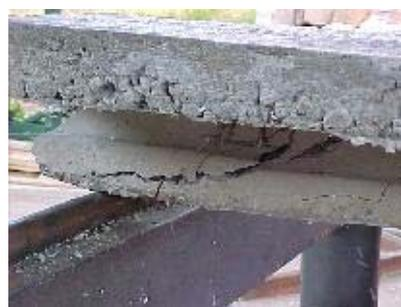
**FOTOGRAFIA 4.6 - fissura na lateral da nervura após o colapso, concreto junto ao apoio se soltou. Inclinação das trincas menor que  $45^{\circ}$**
