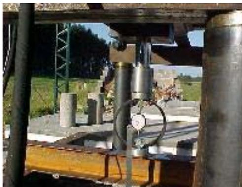
**FOTOGRAFIA 5.3 Anel dinamométrico**
