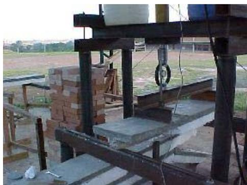
**FOTOGRAFIA 4.1– Ensaio de cisalhamento com pórtico, macaco, dinamômetro e nervura isolada**
