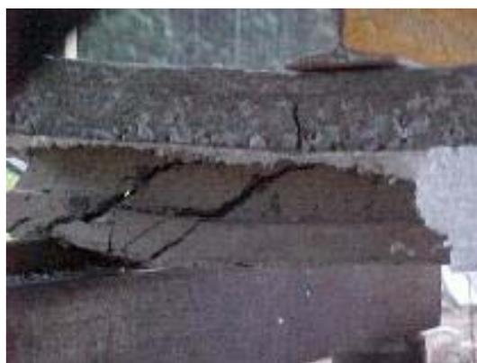
**FOTOGRAFIA 4.3 – fissura na lateral da nervura após o colapso, trincas a um ângulo próximo de  $45^{\circ}$**
