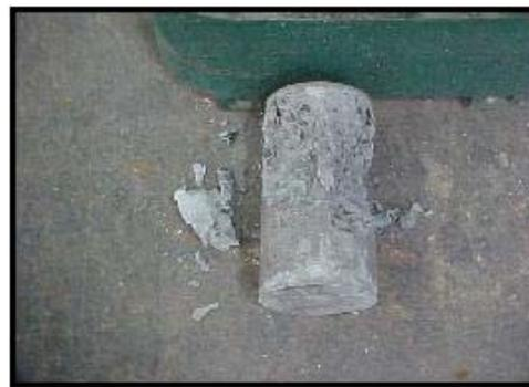
**FOTOGRAFIA 5.5 - corpo de prova após ensaio de compressão.**
