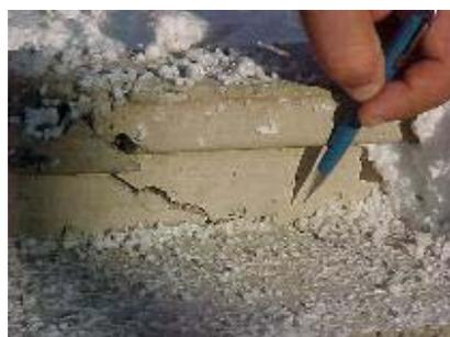
**FOTOGRAFIA 4.5 –fissura na lateral da nervura após o colapso, carga a 35 cm do apoio, inclinação de trincas é menor que  $45^{\circ}$**
