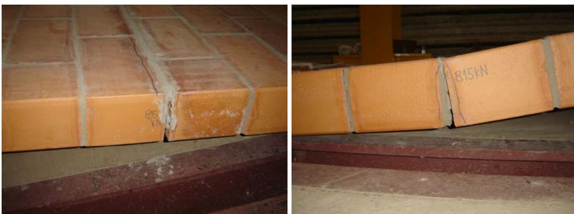
**Figuras 100 e 101-Detalhe da fissuração nas juntas de união das pequenas paredes do painel 2, após a ruptura**
