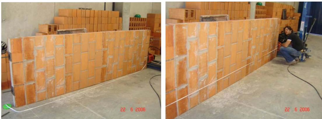
**Figuras 55 e 56 – Detalhes do painel anteriormente à aplicação da protensão e medição do comprimento entre pontos de ancoragem**
