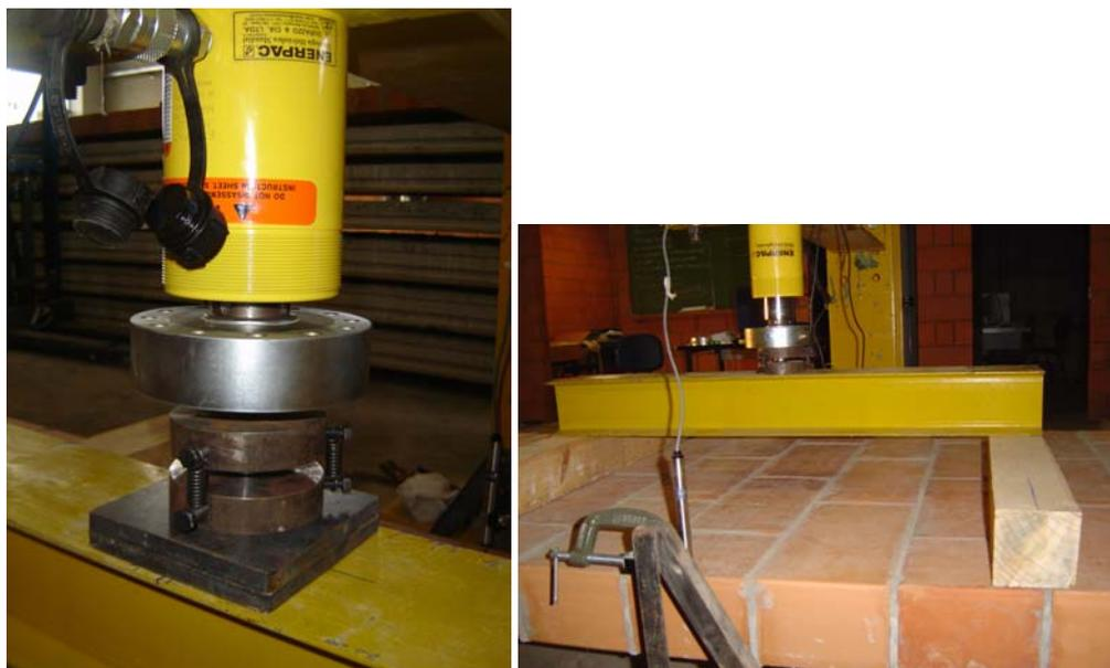
**Figuras 85 e 86- Detalhes dos dispositivos de aplicação e medição de carga**
