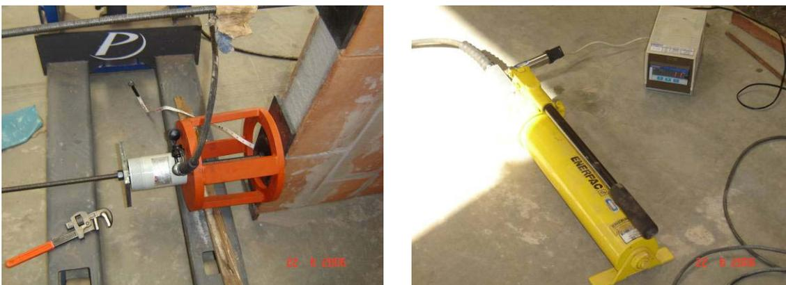
**Figuras 53 e 54 – Equipamentos para protensão : macaco hidráulico e gaiola, bomba hidráulica e medidor de pressão**
