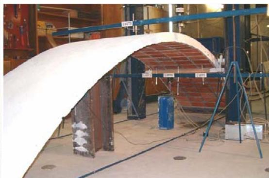
**Figuras 19 e 20- Montagem do painel e o mesmo concluído, preparado para o ensaio (OLIVEIRA, 2005)**
