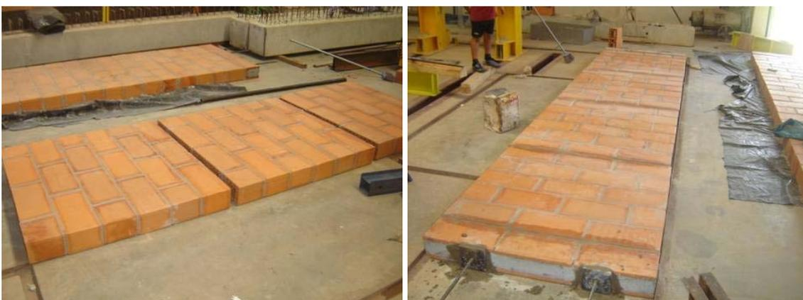
**Figuras 79 e 80 – União de pequenas paredes para formação do painel 2**
