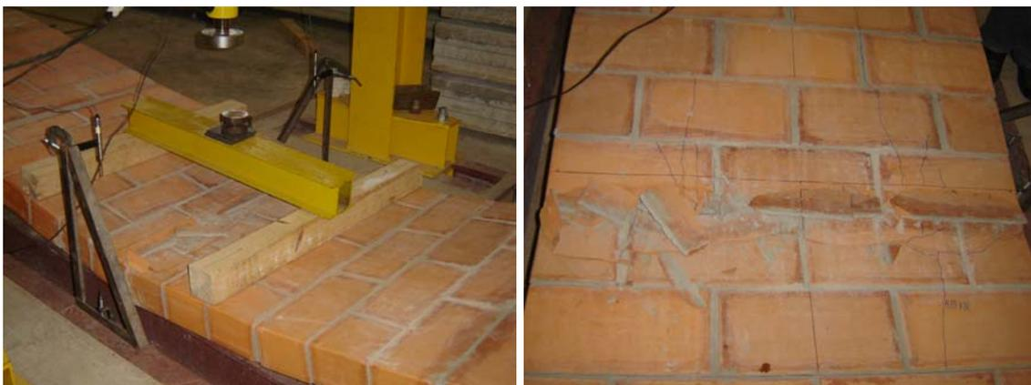
**Figuras 96 e 97- Vista geral do painel 2 no instante da ruptura**
