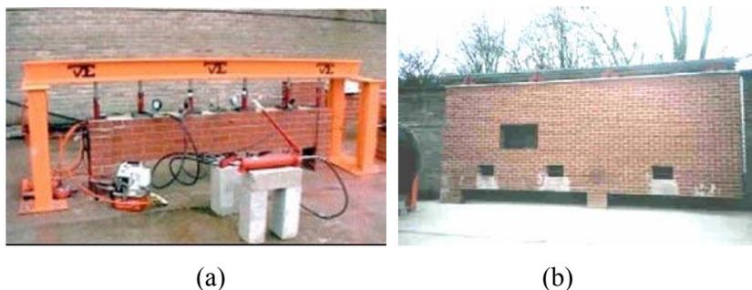
Figura 13- (a) Ensaio de viga protendida; (b) Parede com viga protendida na base (Van Elle Holdings Limited, [www.van-elle.co.uk](http://www.van-elle.co.uk), acesso em 01.03.2006)
