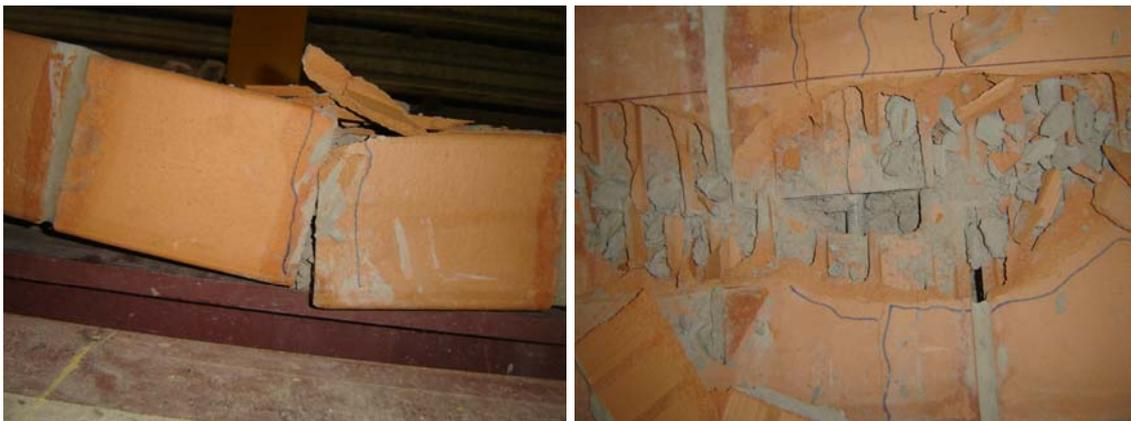
**Figuras 98 e 99-Detalhe da junta central do painel 2 após a ruptura**
