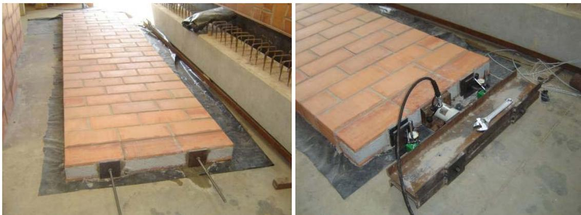
**Figuras 71 e 72 – Aplicação da protensão no painel 1**
