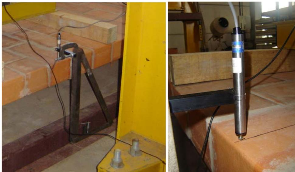
**Figuras 88 e 89 - Detalhe do posicionamento dos transdutores de deslocamentos**
