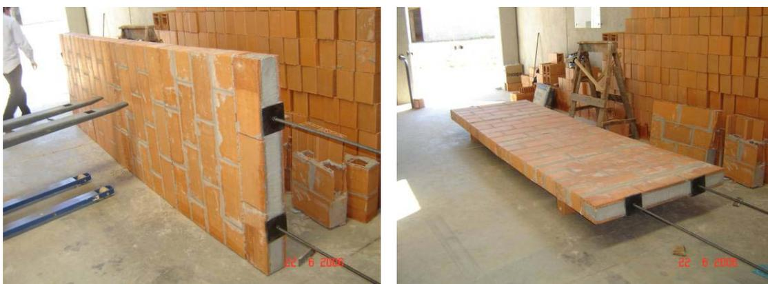
**Figuras 57 e 58 – Detalhes do painel após aplicação da protensão com o plano na direção vertical e horizontal**
