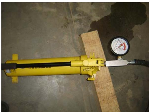
**Figura 87- Detalhe da bomba utilizada na aplicação de carga**
