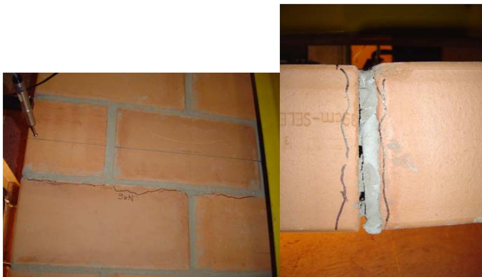
**Figuras 93 e 94- Detalhe da fissuração no painel 1 e da junta central após descarregamento**
