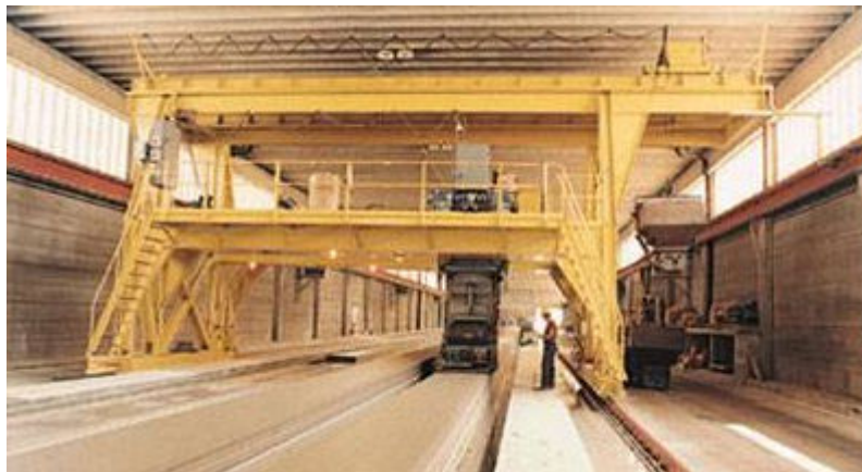
Figura 2.5: Produção de painéis alveolares (PAIVA, 2002)
