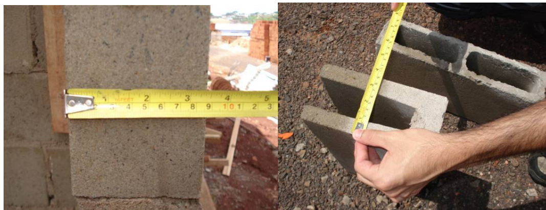
Figura 1. 2 Espessura de blocos de concreto de edificações de alvenaria estrutural.
