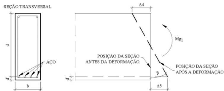
Figura 5-3: Deformação da seção após peso próprio.
