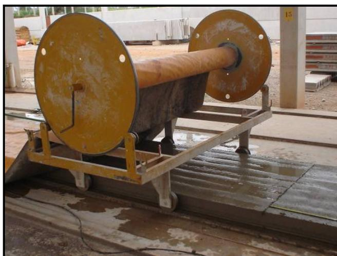
**Figura 2.9:** Cura com lona térmica.
