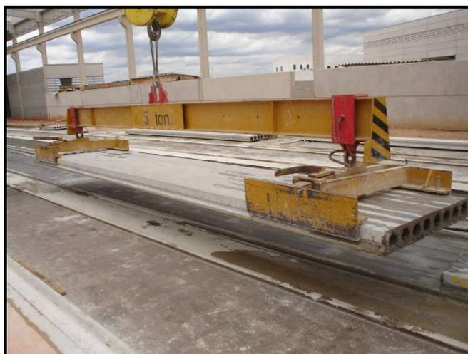
**Figura 2.11:** Içamento das lajes utilizando o sistema de garras e balancins.
