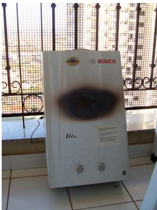
**Figura E.10** – Aquecedor danificado
