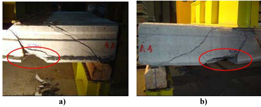
Figura 4.8: Abertura de fissura da laje L04-20-SC-6_C: a) Vista lateral - lado esquerdo; b) Vista lateral - lado direito.
