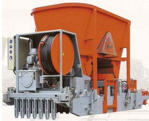
Figura 1.7: Máquina utilizada na fabricação pelo método da forma deslizante [Echo (2008)].
