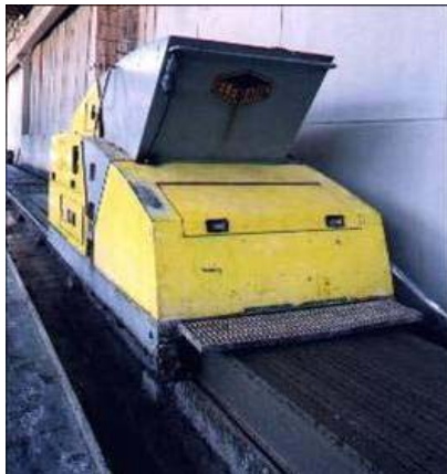
Figura 1.8: a) Máquina Extrusora b) Detalhe das hélices [EDEKLING et all (2006)].
