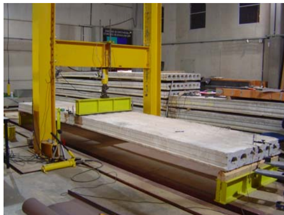
Figura 3.16: Ensaio de flexão de uma laje de 6,5 m no Laboratório do NETPRE-UFSCar.
