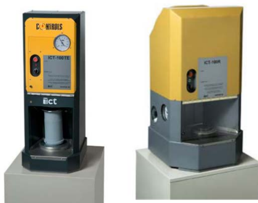
Figura 3.10: Máquinas utilizadas em Ensaio de compactação de concreto com baixa trabalhabilidade [(INVELOP OY, 2009)].
