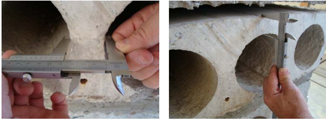
Figura 3.1: Uso de paquímetro para retirada de medidas: a) da nervura b) da borda superior.
