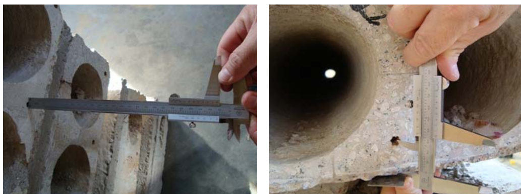
Figura 3.2: Uso de paquímetro para retirada de medidas: a) diâmetro do alvéolo b) altura da laje.
