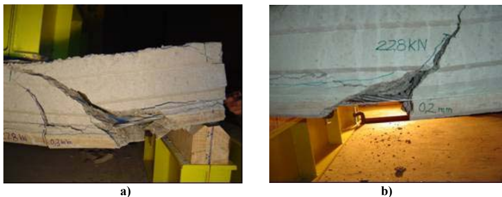
Figura 4.4: Abertura de fissuras durante o ensaio de cisalhamento: a) Vista lateral - lado esquerdo; b) Vista lateral - lado direito.
