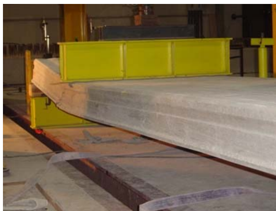
Figura 3.19: Ensaio de Interação de Cisalhamento e Flexão realizado no Laboratório NETPRE-Ufscar.
