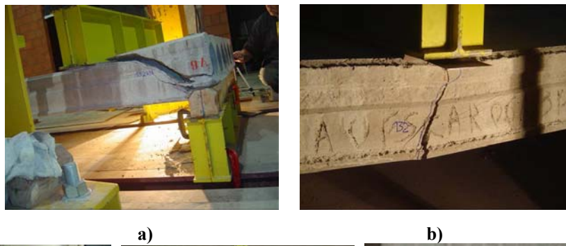
Figura 4.8: Abertura de fissura da laje L04-20-SC-6_C: a) Vista lateral - lado esquerdo; b) Vista lateral - lado direito.
