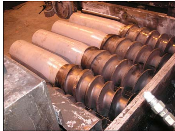
Figura 1.8: a) Máquina Extrusora b) Detalhe das hélices [EDEKLING et all (2006)].
