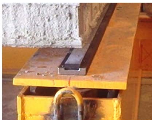
Figura 3.7: Detalhe do material para regularizar a superfície da laje [Fernandes (2007)].
