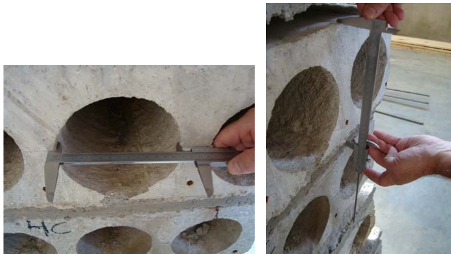
Figura 3.2: Uso de paquímetro para retirada de medidas: a) diâmetro do alvéolo b) altura da laje.
