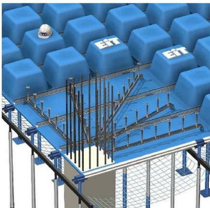
Figura 4.4.2-1 - Lajes lisas nervuradas com uso de cubetas (detalhe do capitel com armadura de punção). Fonte: <http://www.eit-es.com>
