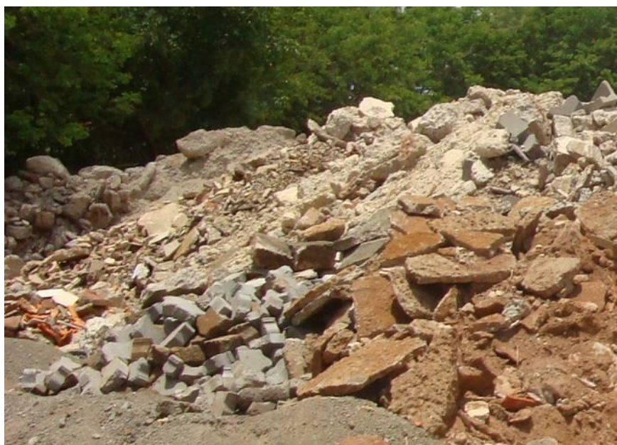
Figura 4.38 - Resíduos de concreto Fonte: Autor, Dezembro de 2011
