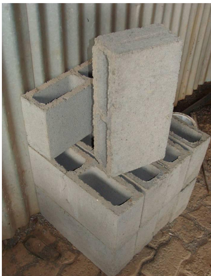
Figura 4.55 - Blocos de concreto produzidos na FAC, sem adição de agregados reciclados Fonte: Autor, Dezembro de 2011
