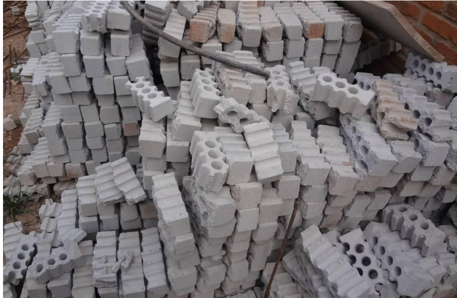
Figura 4.21 – Resíduos de bloco estrutural para utilização em vedação Fonte: Autor, Novembro de 2010
