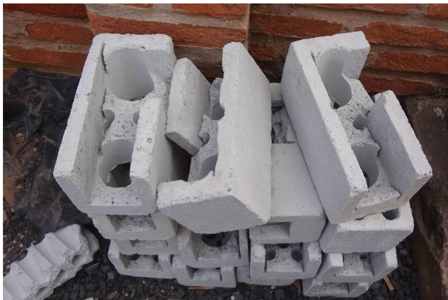
Figura 4.22 – Resíduos de bloco estrutural para utilização como canaleta Fonte: Autor, Novembro de 2010
