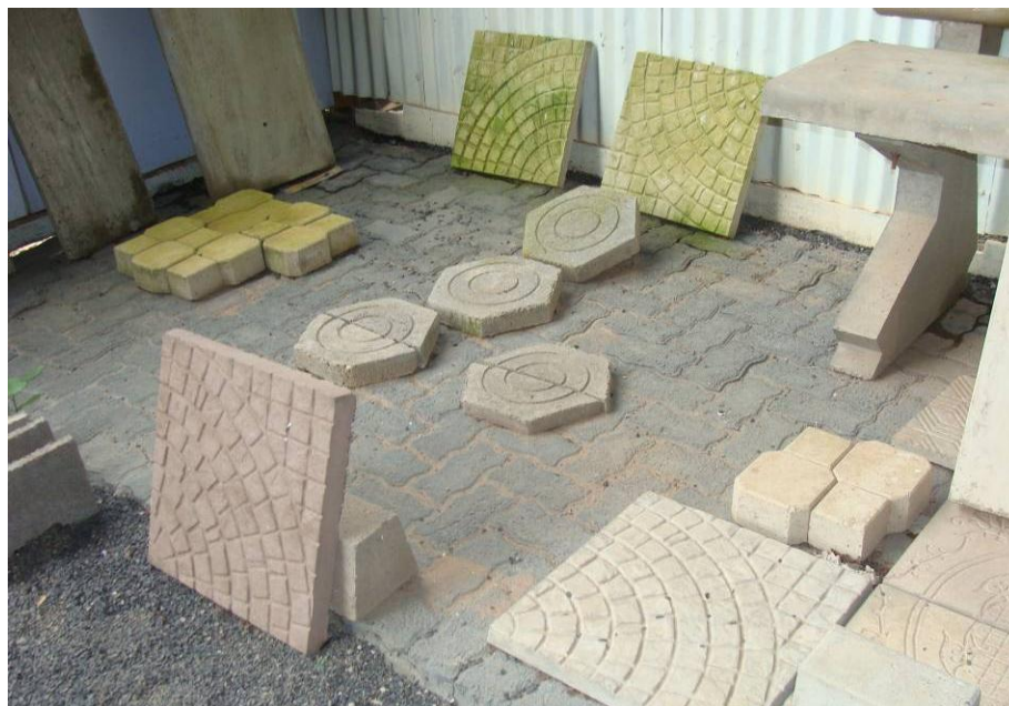
Figura 4.58 - Diversos produtos de concreto produzidos na FAC, com adição de agregados reciclados (calçada, banco, passeios, etc) Fonte: Autor, Dezembro de 2011
