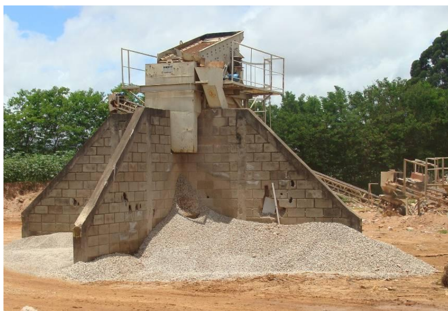
Figura 4.50 - Separador de agregados reciclados
