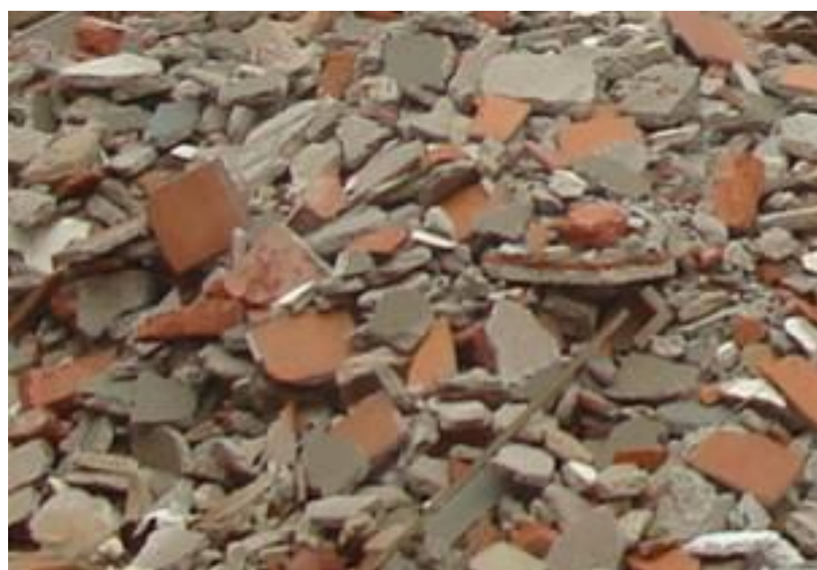
Figura 4.43 - RCC com resíduos de cerâmica junto ao concreto
