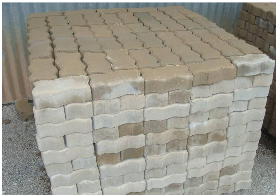
Figura 4.56 - Bloquetes de concreto produzidos na FAC, sem adição de agregados reciclados Fonte: Autor, Dezembro de 2011
