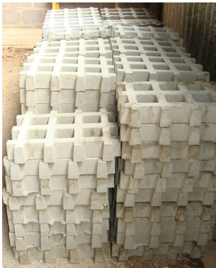
Figura 4.59 - Bloco-grama produzidos na FAC, com adição de agregados reciclados Fonte: Autor, Dezembro de 2011
