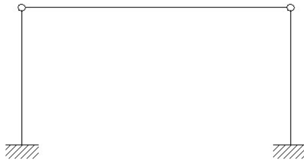
Figura 3.9: Esquema estrutural do galpão com trave horizontal.
