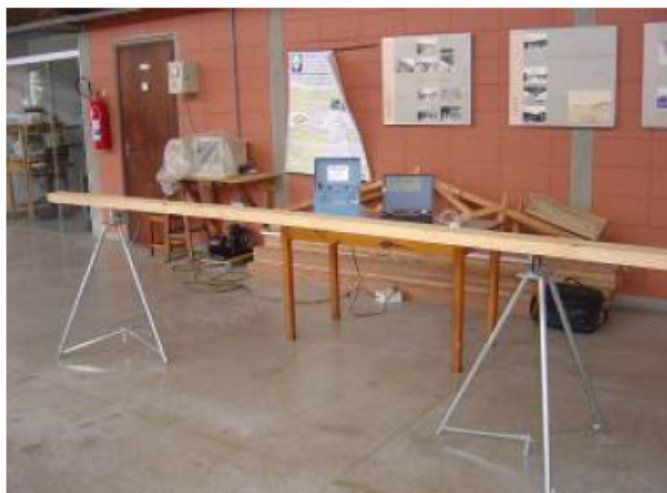
Figura 38 – Ensaio com o emprego da técnica de vibração transversal
