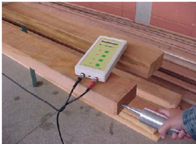
Figura 46 – Ensaio de ultrassom
