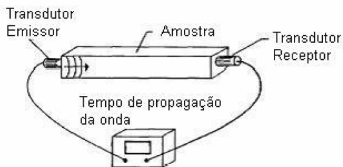
Figura 27 – Ensaio de ultrassom – técnica de transmissão
