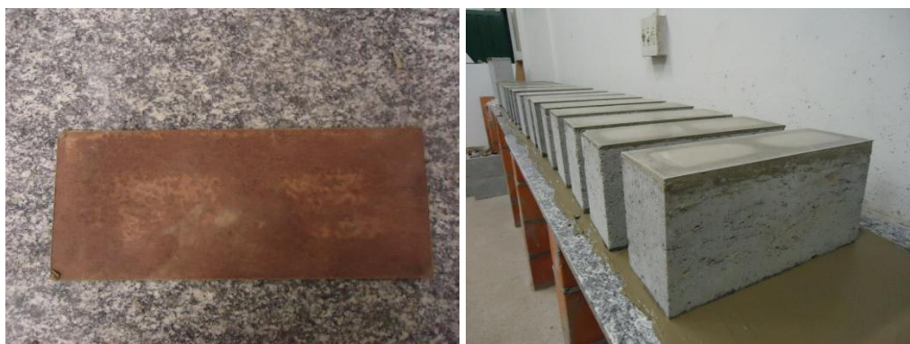
Figura 37 – Ilustração da chapa dura e do capeamento com pasta de cimento ( foto autor ).
