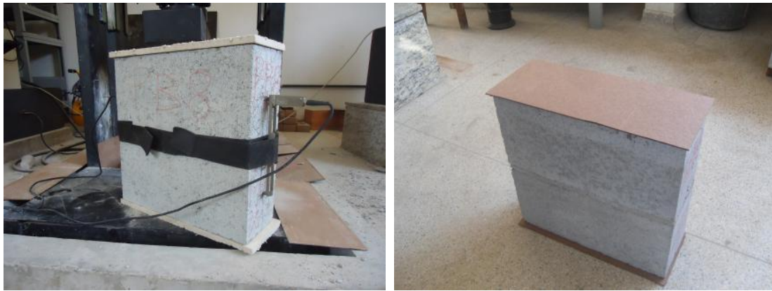
Figura 26 – Ilustração do processo de regularização da superfície dos prismas e blocos com material seco ( foto autor )
