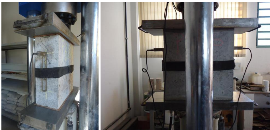
Figura 38 – Ensaio de compressão axial com obtenção dos deslocamentos ( foto autor ).
