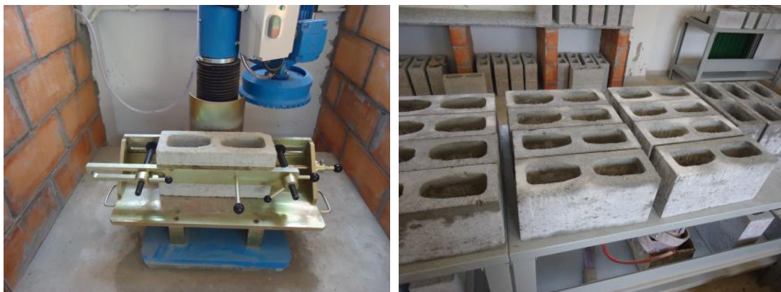
Figura 28 - processo de reificação do bloco ( foto autor )
