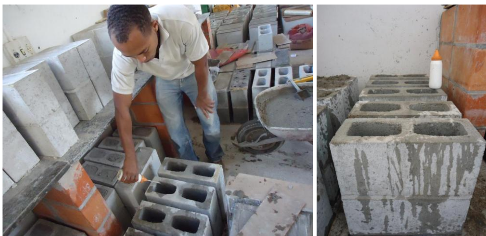
Figura 29 - Ilustração da molhagem previa do prisma grauteado ( foto autor )
