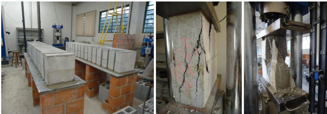
Figura 36 – Ilustração do capeamento e dos ensaios dos prismas grauteados ( foto autor ).
