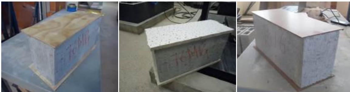
Figura 22 – Ilustração dos capeamentos com material seco, respetivamente, madeira compensada, forro pacote e chapa dura ( foto autor ).
