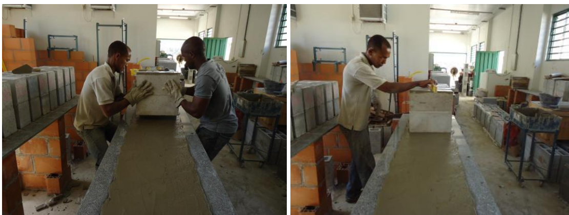
Figura 25 - Ilustração do processo de capeamento com pasta de cimento ( foto autor )
