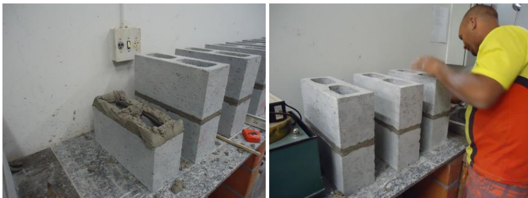
Figura 31 – Moldagem dos prismas (foto autor).
