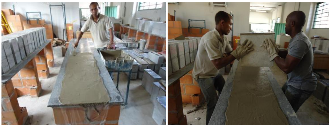
Figura 24 – Ilustração do processo de capeamento com pasta de cimento ( foto autor )
