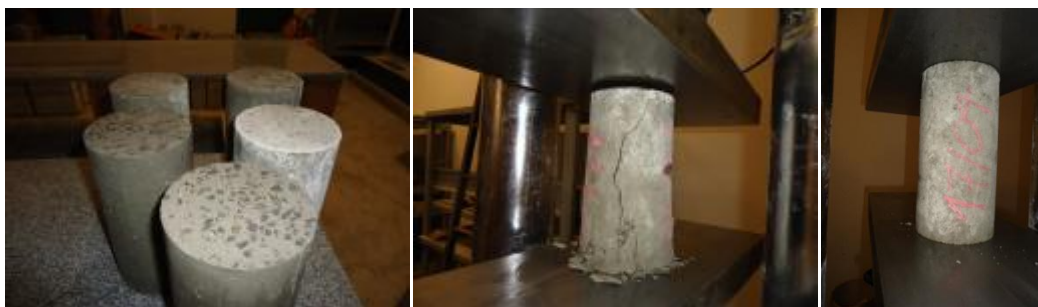
Figura 40 – Ilustração do ensaio de compressão do graute ( foto autor )
