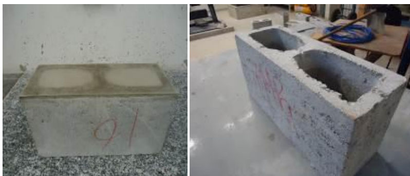
Figura 23 - Ilustração do capeamento com pasta de cimento e a retifica respetivamente ( foto autor ).
