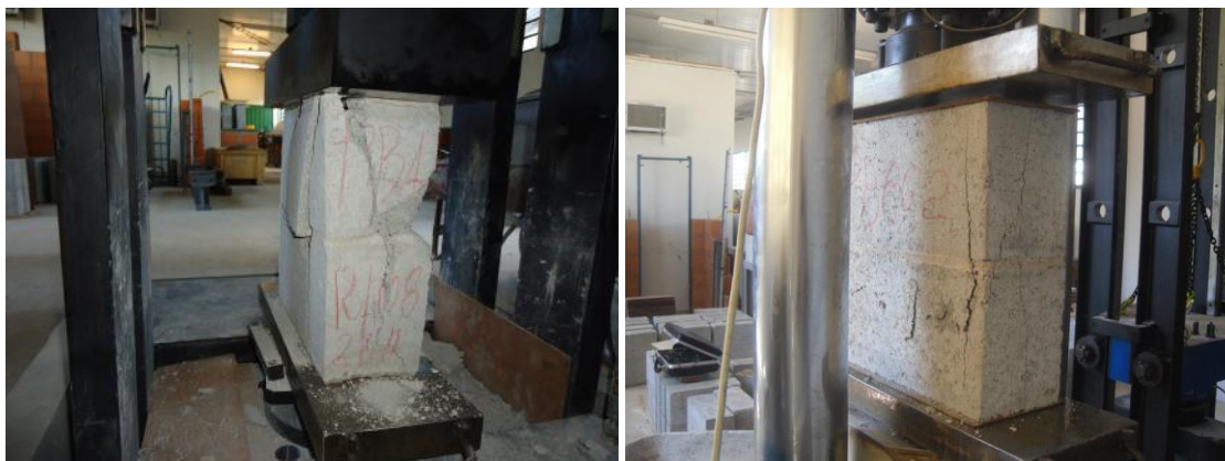
Figura 45 - Ilustração do ensaio com os dois tipos de capeamento (foto autor)
