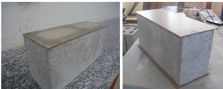
Figura 33 – Ilustração do (a) Capeamento com pasta de cimento, e do (b) capeamento com chapa dura ( foto autor ), respectivamente.
