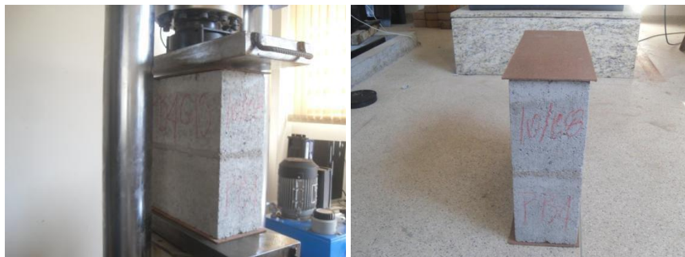
Figura 35 - Ilustração do capeamento e dos ensaios dos prismas não grauteados (foto autor)
