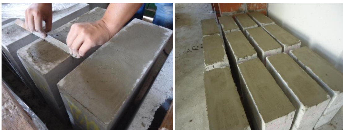
Figura 30 – Ilustração da regularização da fase superior do prisma grauteado com pasta de cimento ( foto autor )
