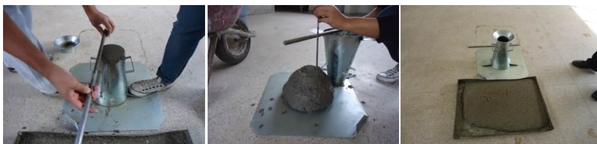
Figura 13 – Ilustração do ensaio de consistência do graute – Slump Test (fotos do autor)
