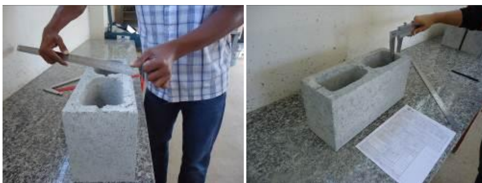
Figura 15 - Medição das mísulas e das paredes dos blocos
