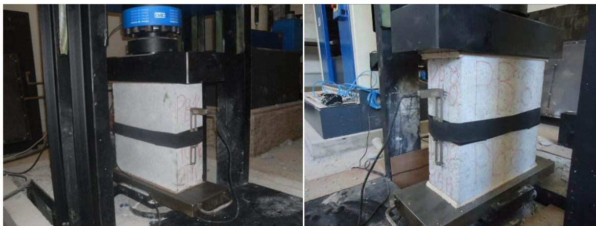
Figura 21 – Colocação dos extensômetros elétricos.
