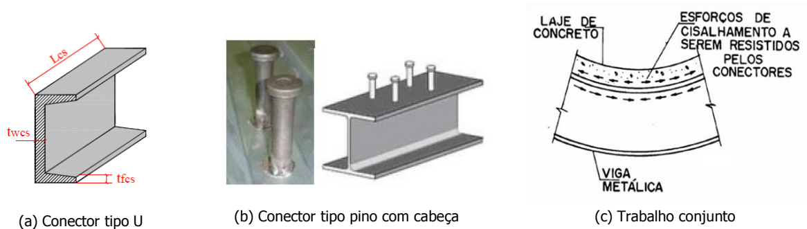
Figura 3.5 – Conectores de cisalhamento soldados a viga metálica
