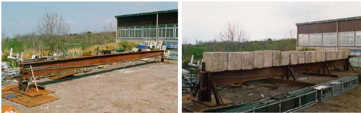
Figura 2.6 – Ensaio de uma viga metálica protendida
