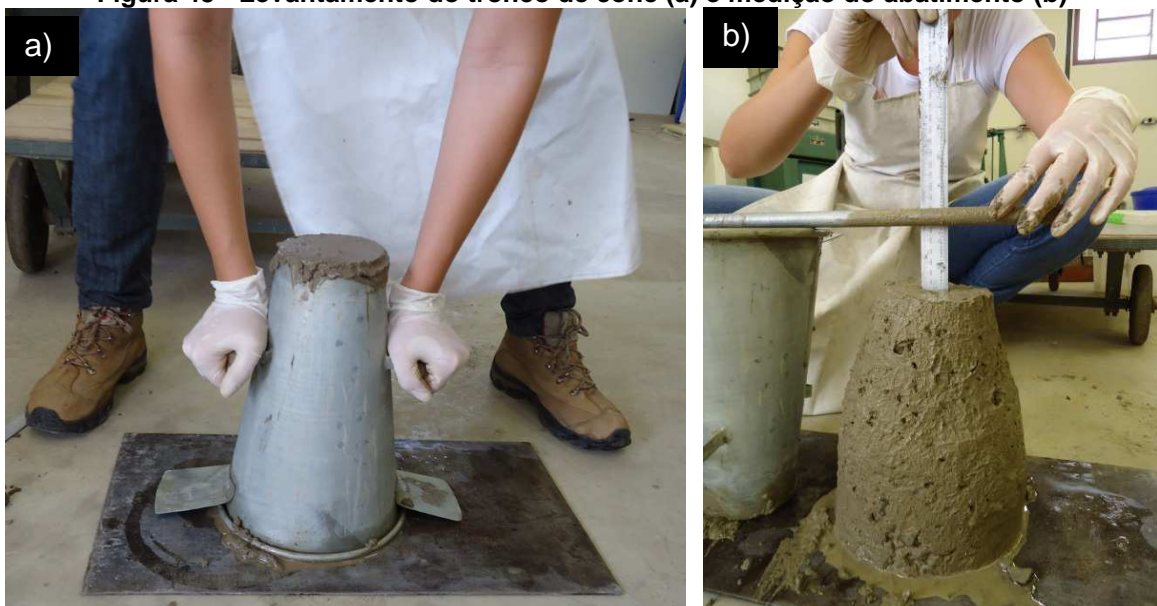
Figura 45 - Levantamento do tronco de cone (a) e medição do abatimento (b)
