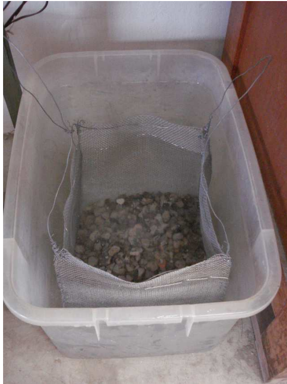
Figura 37 – RCC submergido em água
