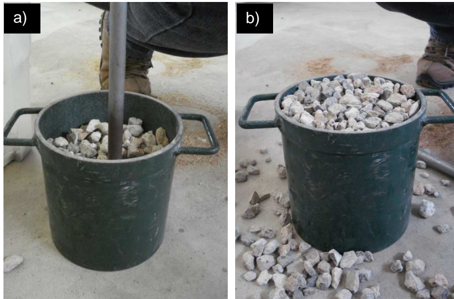
Figura 41 – Massa unitária compactada do RCC: golpes aplicados com a haste de adensamento (a), camada nivelada (b)
