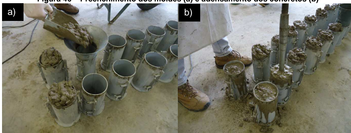
Figura 46 – Preenchimento dos moldes (a) e adensamento dos concretos (b)
