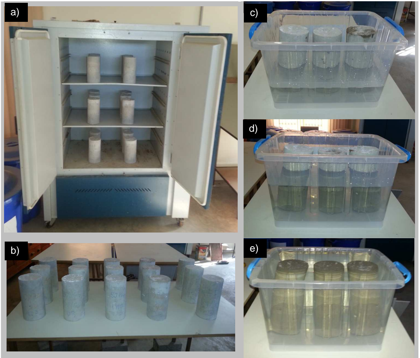
Figura 53 – Procedimento do ensaio de absorção, índice de vazios e massa específica, (a) secagem dos corpos de prova na estufa, (b) resfriamento dos corpos de prova, (c) imersão de 1/3 do volume dos corpos de prova, (d) imersão de 2/3 do volume dos corpos de prova, (e) imersão total dos corpos de prova
