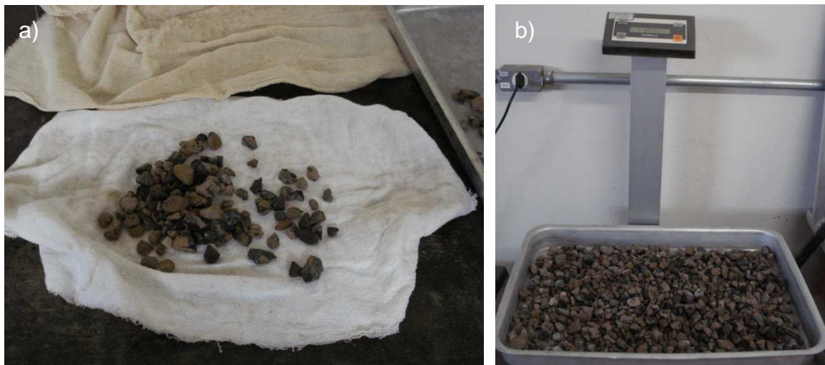
Figura 38 – Secagem da água visível do grãos (a), determinação da massa saturada com superfície seca (b)
