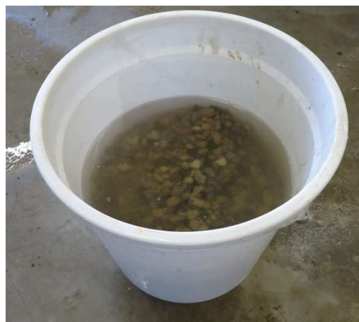
Figura 43 – Pré-molhagem do RCC
