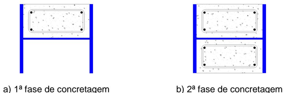
Para os pilares mistos parcialmente revestidos (FIGURA 1.3b) pode-se notar que, apesar de o concreto preencher a região entre as mesas do perfil de aço e, conseqüentemente, aumentar sua capacidade resistente, não protege totalmente o perfil contra a corrosão e o fogo, podendo ser necessário lançar mão de outros dispositivos de proteção para tais finalidades. Estes dispositivos adicionais de proteção também podem ser necessários nos outros tipos de pilares mistos.
