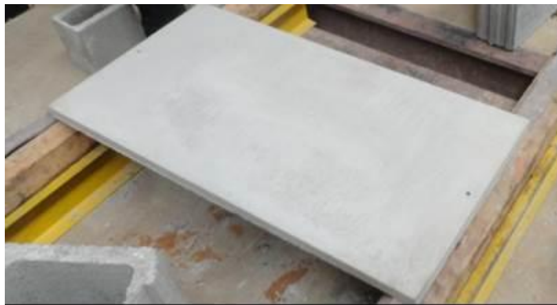
Figura 35: Placa de concreto usada no fechamento formando as paredes
