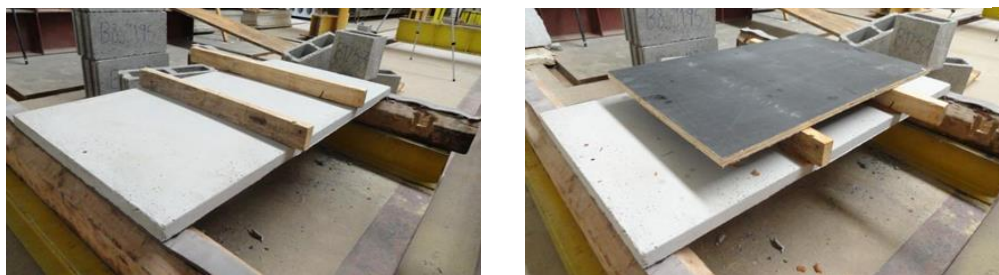
Figura 56: Esquema de montagem das placas a serem ensaiadas
