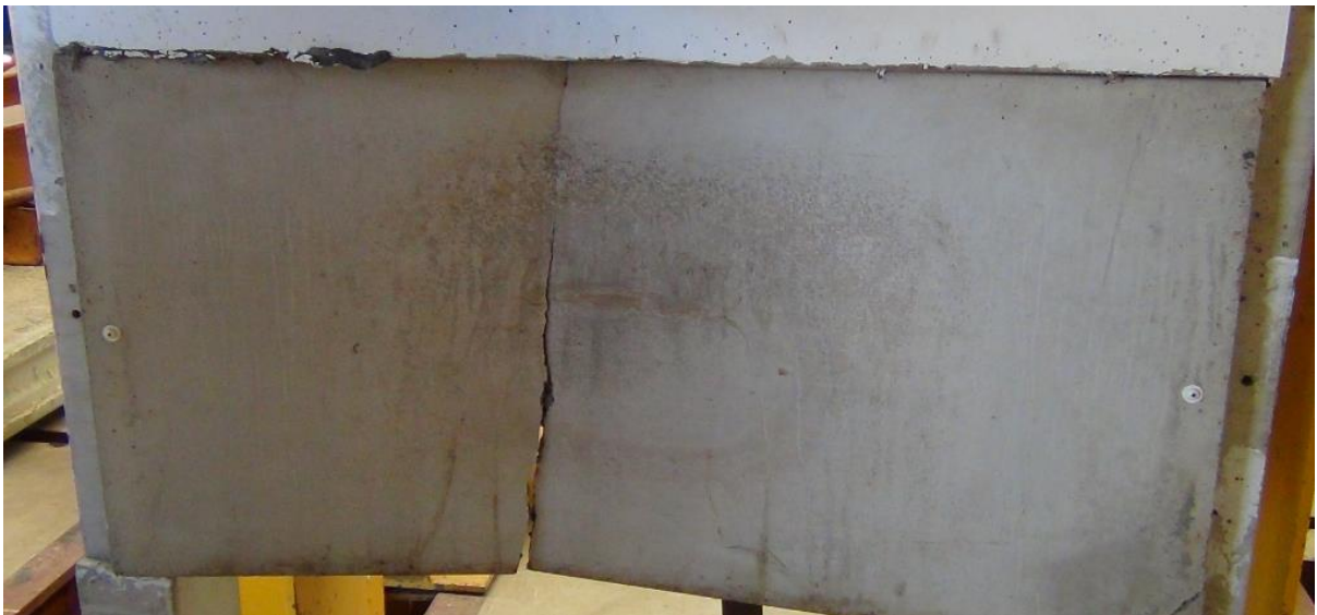
Figura 69: Ensaio realizado corpo mole
