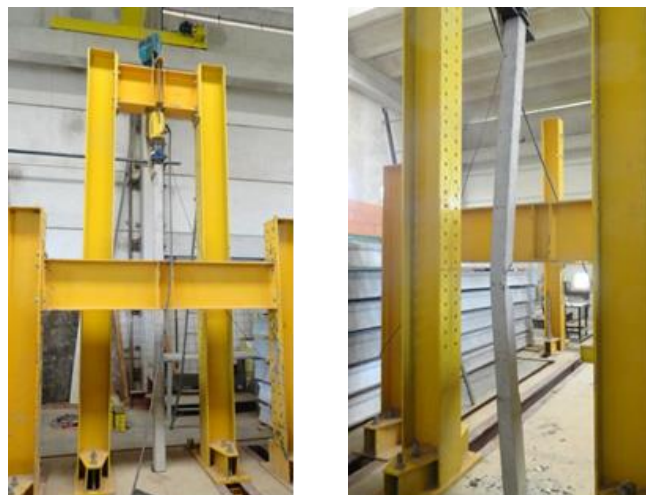
Figura 53: Ensaio compressão axial dos montantes
