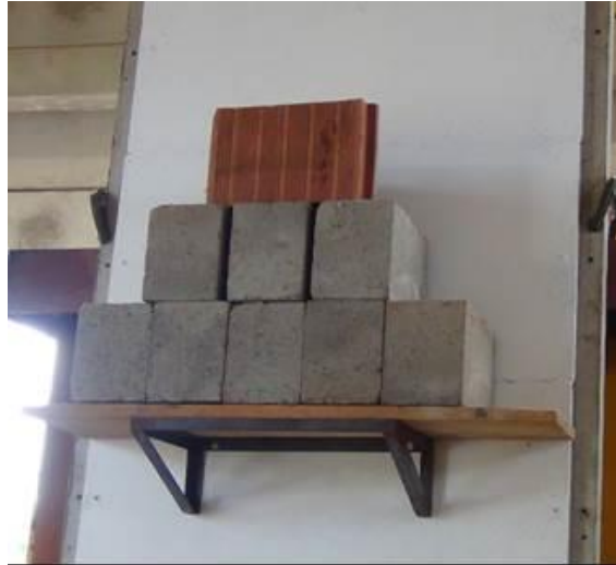
Figura 59: Carga suspensa na parede 1,20kN período de 24h
