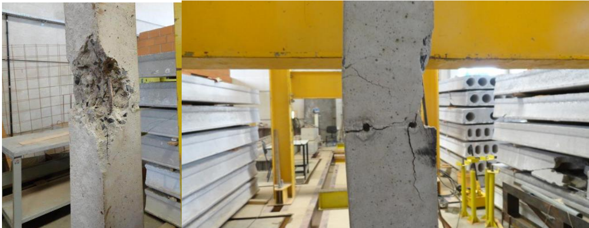
Figura 54: Ensaio de compressão axial do montante, pré-moldado.
