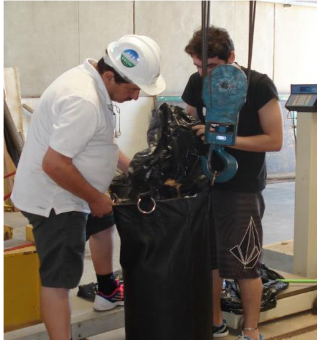
Figura 65: Preenchimento do saco com areia e serragem peso de 40kg
