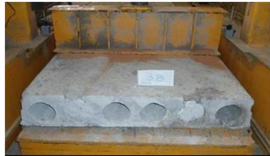
Modelo montado para ensaio
