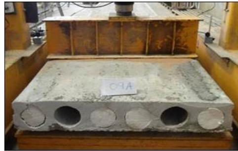
Modelo montado para ensaio
