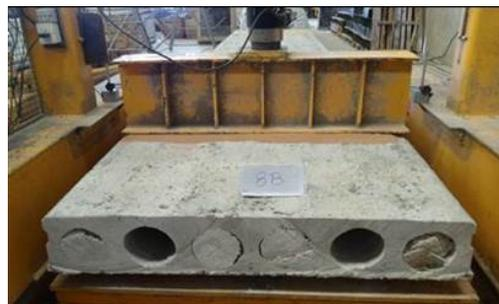
Modelo montado para ensaio
