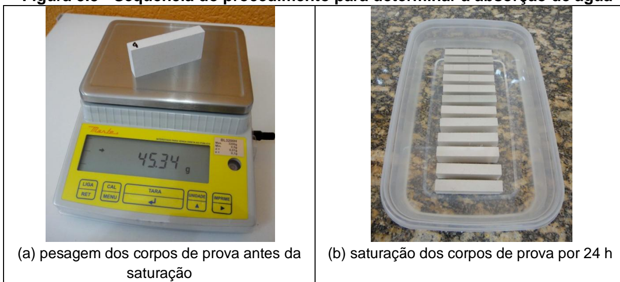
Figura 3.8 - Sequência do procedimento para determinar a absorção de água
