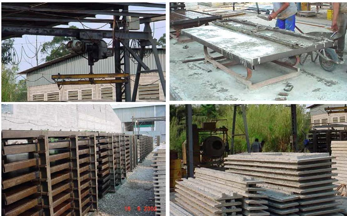
Figura 15 – Equipamentos utilizados na fabricação dos painéis e estocagem no sistema Premium
