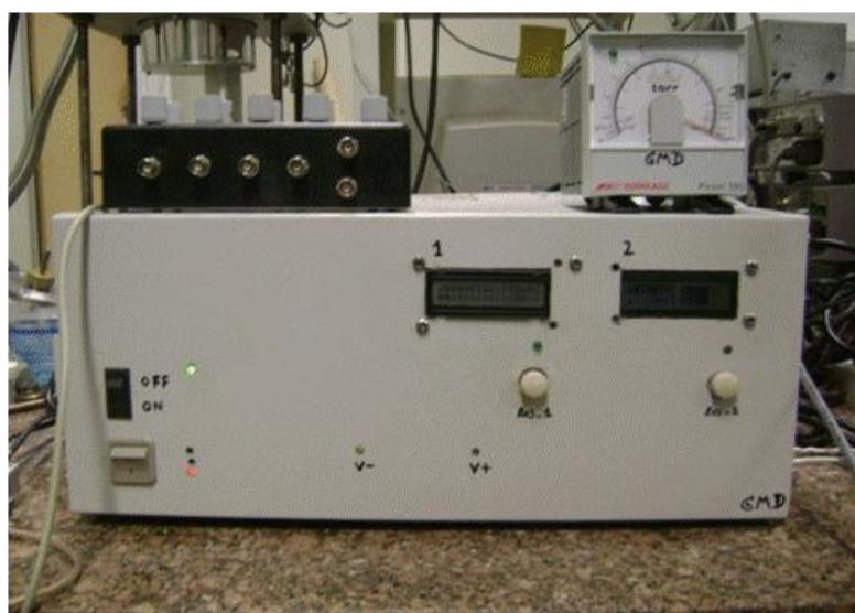
Figura 5.18: Fotografia da fonte finalmente armada e funcionando. Acima da fonte podemos observar o MFP-chaveador que será descrito nas seguintes seções e o medidor de vácuo para o criostato e câmara da amostra.
