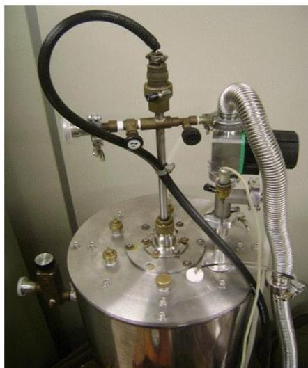
Figura 5.24: Tampa modificada conforme o mencionado acima, novo feedthrough para o sensor S.Q.U.I.D., válvula de segurança e sistema de bombeio de vácuo, além da conexão para a manguera de silicone a qual é ligada ao sistema de recuperação de He, também podemos observar as duas varetas (18 e 10 pinos) ligadas suas respectivas tomadas. Ao lado do criostato podemos ver a válvula de controle de vácuo das paredes do criostato.
