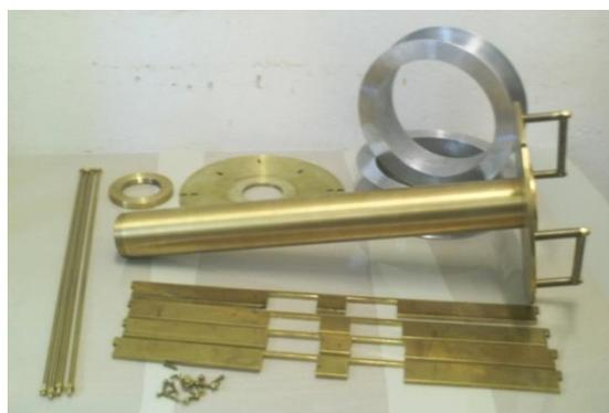
Figura 5.11: Peças para montagem dos carretéis das bobinas central e correctoras.
