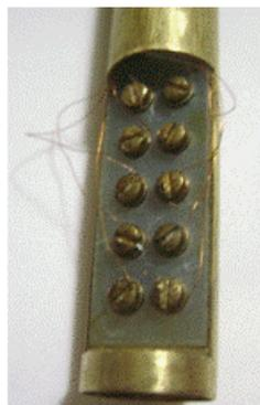
Figura 5.34: Conectores internos do MFP (embutido no sensor S.Q.U.I.D. e acessórios).
