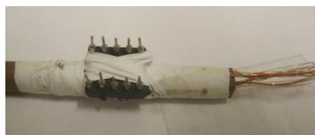
Figura 5.28: Conector da vareta de 10 pinos, dentro do criostato
