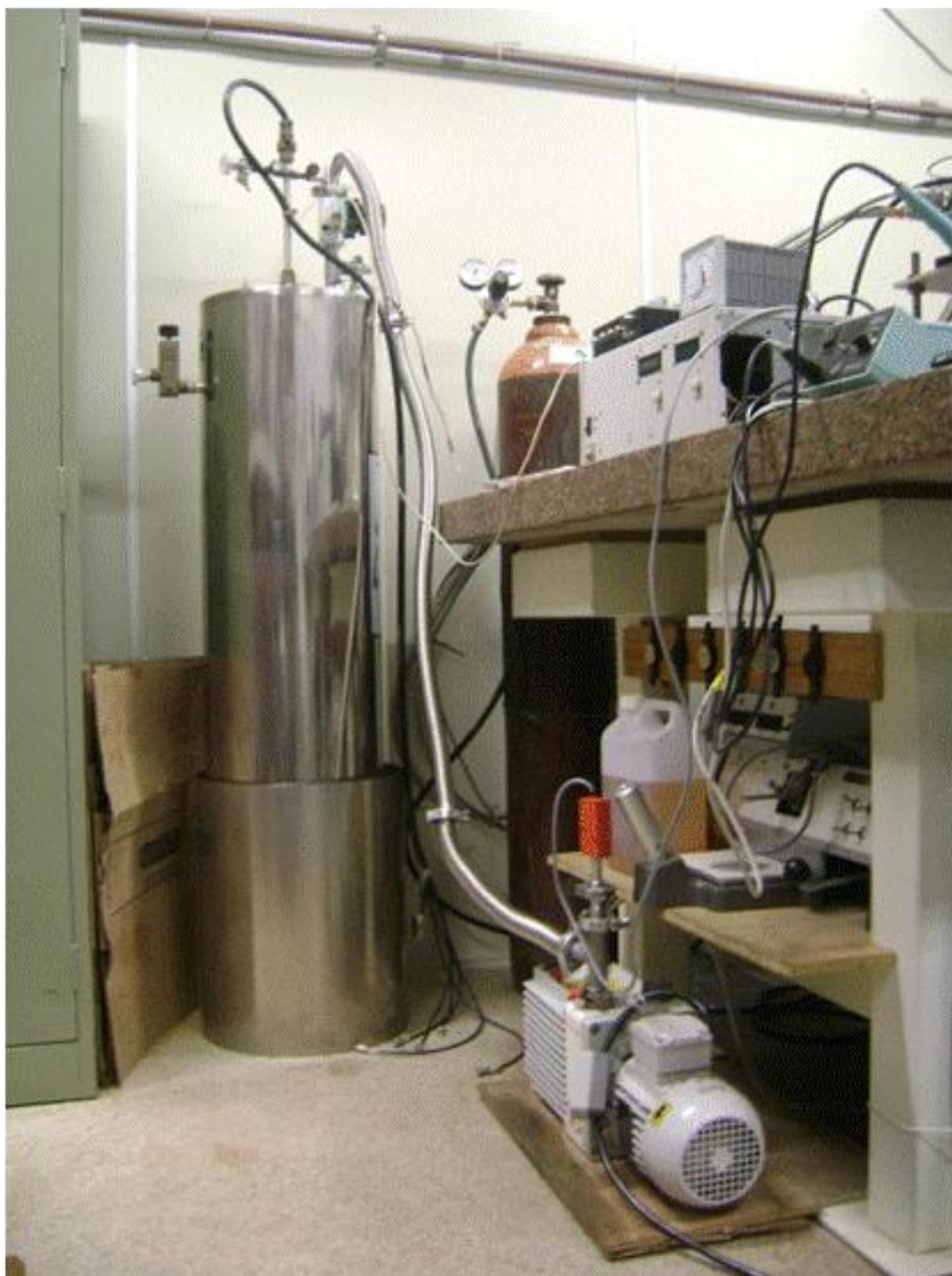
Figura 5.45: Fotografia que mostra a montagem pronta do sistema tal como é descrito anteriormente. Observa-se o criostato, fonte de corrente, o MFP-chaveador, recinto de gas He, que é utilizado para purgar o recinto da porta-amostra, o controlador e a bomba de vácuo, entre outros.
