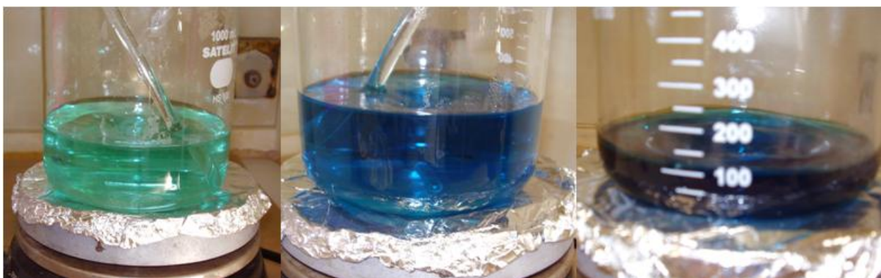
Figura 6-2 – Fotos das etapas 2 e 3 mostrando a mudança na cor da solução quando o pH é aumentado. Na última foto já se observa uma importante evaporação da água, para a posterior formação do gel .
