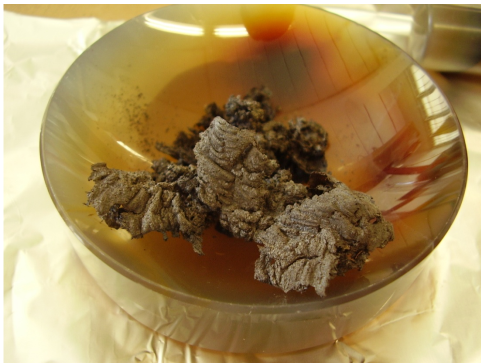
Figura 6-3 – Foto do pó obtido após a queima do polímero.
