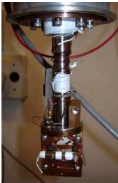
Figura 5-7 – Foto do porta-amostras colocado no dedo frio do criostato
