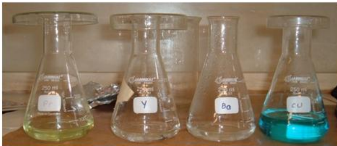
Figura 6-1 – Reagentes utilizados para a preparação do pó precursor ( \text{Pr}_6\text{O}_{11}\text{Y}_2\text{O}_3 , \text{BaCO}_3 , \text{CuO} ), diluídos em ácido nítrico
