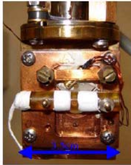
Figura 5-6 – Foto do porta-amostras usado nas medidas de susceptibilidade AC
