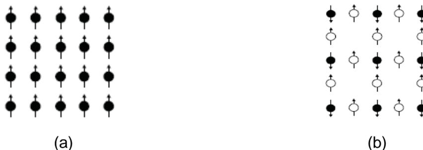
Figura 2. 7 - Representação esquemática da distribuição de dipolos magnéticos em materiais: (a) Ferromagnéticos; e (b) Ferrimagnéticos.
