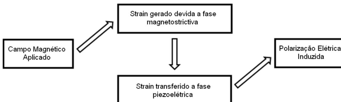
Figura 2. 9 - Representação esquemática da conversão entre energia magnética e elétrica em materiais magnetoelétricos compostos via acoplamento piezoelétrico/piezomagnético.
