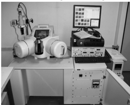
Figura 4.12 – Sistema do AFM-Shimadzu modificado para Microscópio de Piezoresposta no Brasil.
