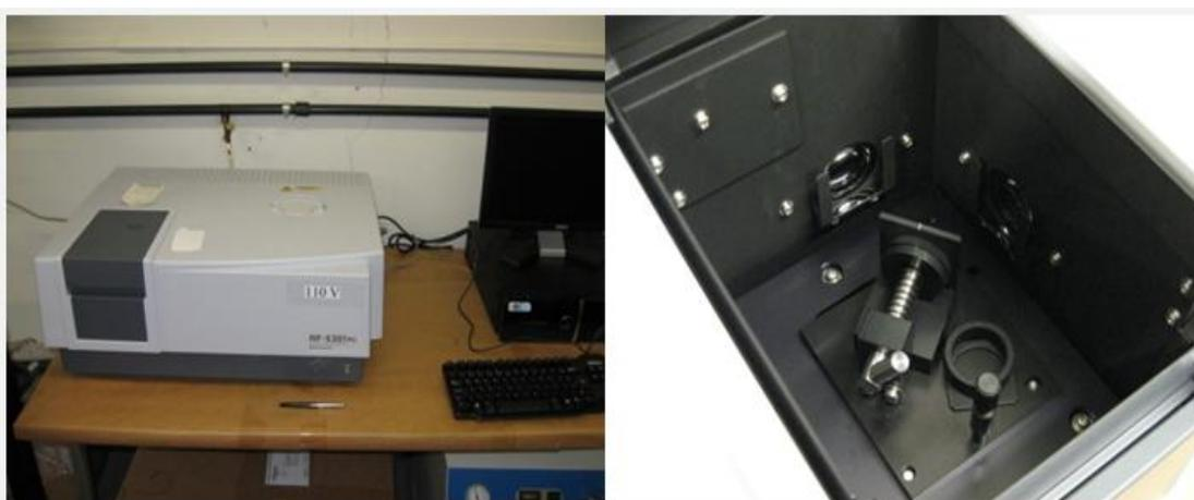
O espectrofluorímetro tem a fenda de saída em 90° com a de entrada (feixe de excitação) que era exatamente a configuração desejada para se recolher a luminescência lateral. Um porta cubeta já ajustado ao foco do feixe de excitação que permitia uma rápida troca de amostras como se mostra na Figura 27.
