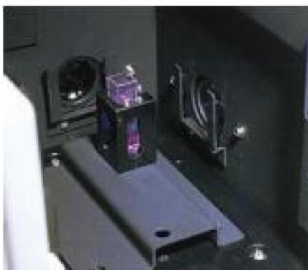
Mas, infelizmente não se conseguiu um feixe de excitação polarizado. É que diferentemente do laser, a potencia da radiação do espectrofluorímetro decai bastante através do polarizador a ponto de não permitir excitar a alumina o suficiente, embora quando excitada naturalmente a luminescência na saída passando pelo mesmo polarizador (analisador) permite a PL ser detectada para uma mesma abertura em ambas as fendas.
