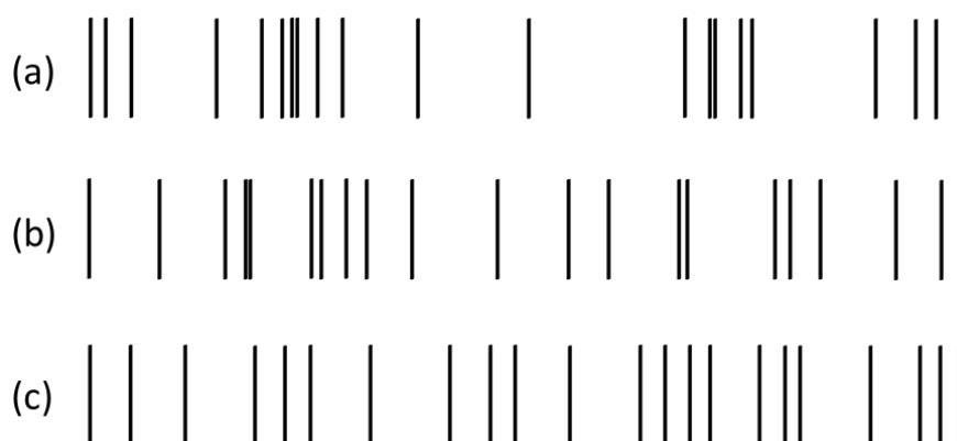
Figure 2.3: Contagem de fótons em função do tempo para campos que apresentam (a) agrupamento de fótons, (b) aleatoriedade (campo coerente) e (c) antiagrupamento de fótons. Esta figura foi retirada da Ref. [92].
