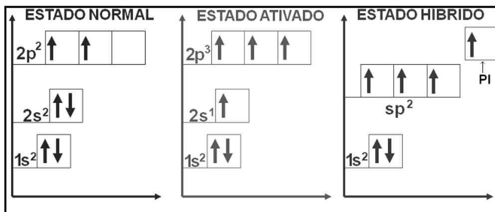
Figura 6 - Diagrama energético das diferentes fases do carbono durante o processo de hibridização sp^2 [33].
