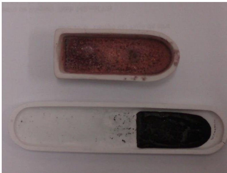
Figura 23 - Cadinhos utilizados para o processo de magnetização do grafite magnético.
