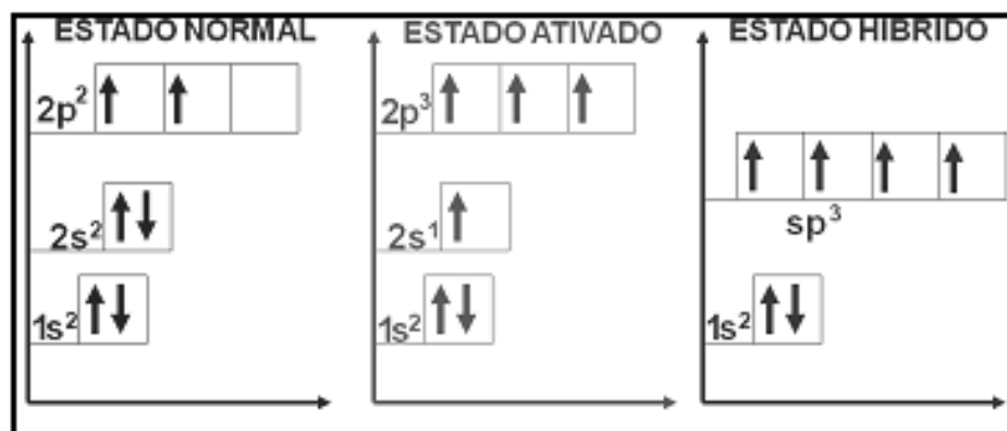
Figura 9 - Diagrama energético das diferentes fases do carbono durante processo de hibridização sp^3 [33] .
