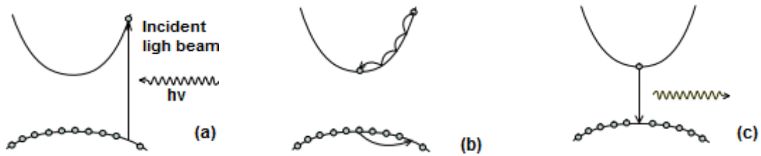
Figura 7: Esquema de (a) excitação, (b) relaxação intra-banda e (c) processo de recombinação/luminescência em semicondutor. Figuras adaptadas da referência [105].
