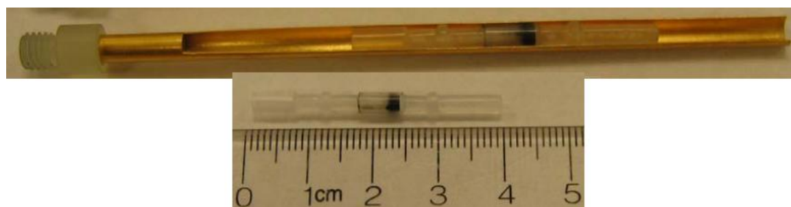
Figura 12: Amostra em forma de pó posicionada em porta amostras de latão utilizado em magnetômetro SQUID.
