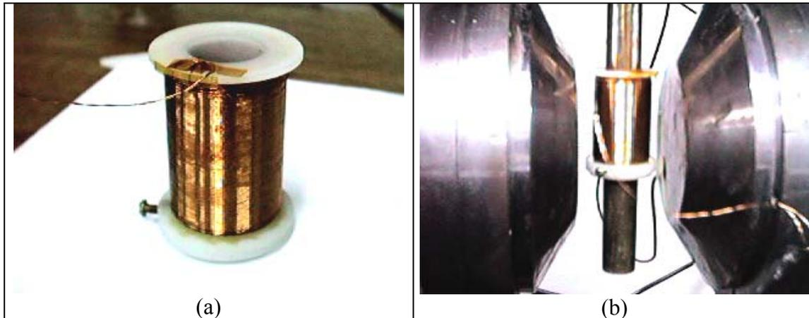
Fotos 3.14: Bobina construída para aplicação de um campo contínuo (c.c.) sobre a amostra.
