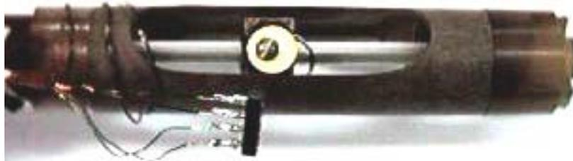
Foto 3.7: Fixado à safira, pode-se ver o termômetro Cernox. A safira é um dos melhores condutores de calor não-metálico, sendo indicado para o nosso sistema.
