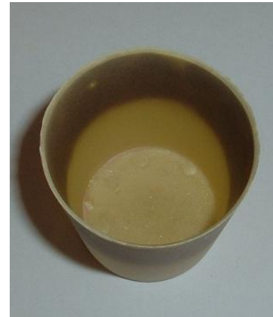
Figura 51 - Cadinho de \text{SnO}_2 após o procedimento de descontaminação, pronto para o crescimento dos cristais.
