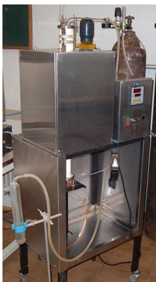
Figura 56 - Forno horizontal usado para o crescimento dos cristais.
