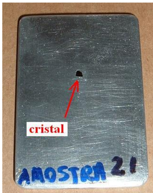
Figura 45 - Porta amostra de alumínio com um monocristal fixado com silicone.
