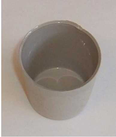
Figura 48 - Cadinho de \text{SnO}_2 retirado do molde de gesso e pronto para ser sinterizado.
