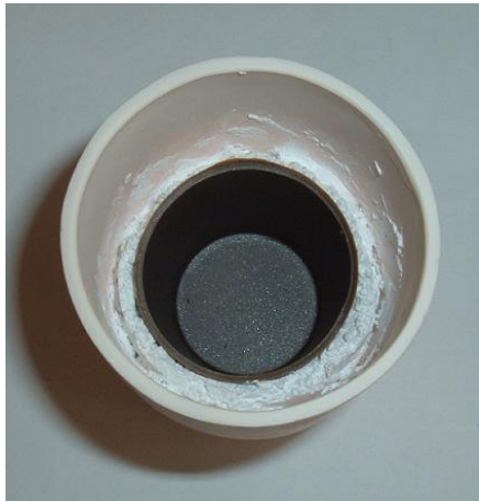
Figura 50 - Cadinho de \text{SnO}_2 já sinterizado e colocado dentro de um cadinho de alumina com alumina em pó em sua volta.
