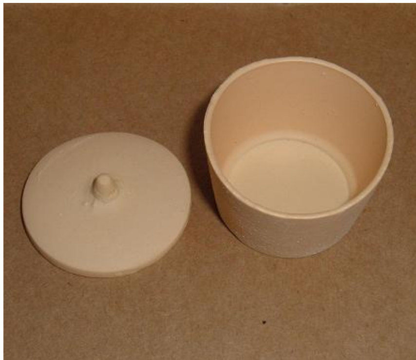
Figura 52 - Cadinho de Zircônia-Céria com tampa utilizado no crescimento de cristais.
