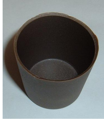
Figura 49 - Cadinho de \text{SnO}_2 após o procedimento de sinterização.
