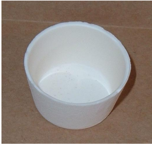
Figura 47 - Cadinho de Al 2 O 3 já sinterizado com suas respectivas dimensões e pronto para ser usado no crescimento dos cristais.
