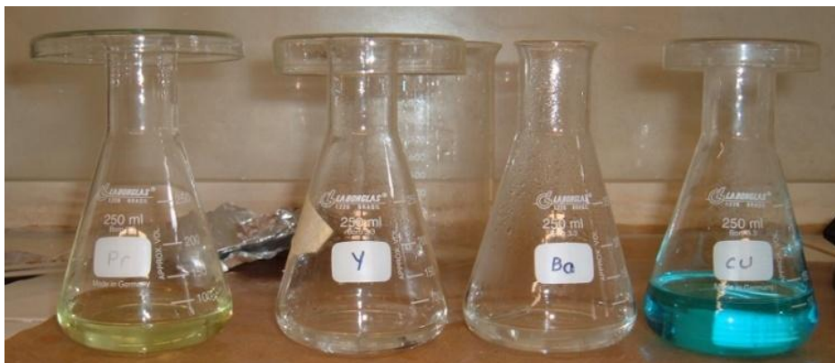
Figura 54 - Recipientes, cada qual com um óxido diferente (Pr, Y, Ba e Cu) já diluídos formando uma solução límpida.
