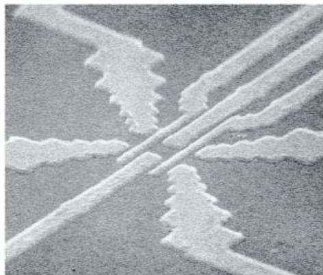
Figura 2.14: Ponto quântico produzido por um campo elétrico modulado. Os quatro eletrodos internos localizam os elétrons e os quatro eletrodos externos servem como contatos para que os elétrons possam tunelar para dentro ou para fora do ponto quântico. Imagem reproduzida da referência [32].
