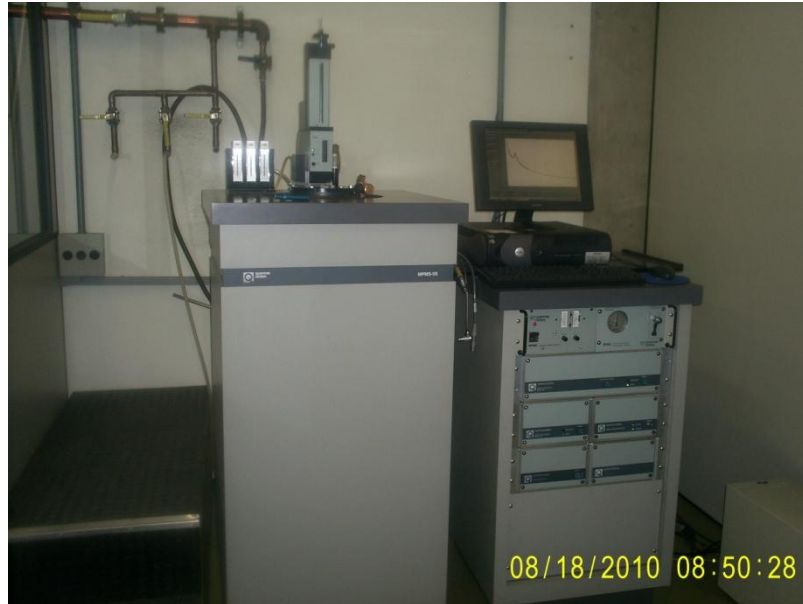
Figura 27: Estação MPMS dotada de um sensor SQUID, utilizada para caracterização magnética das amostras de \text{IrO}_2 e \text{Co:IrO}_2 .
