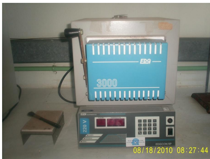
Figura 25: Forno da marca EDGCON 5P utilizado no processo de calcinação das amostras, com capacidade para atingir até 1000°C.
