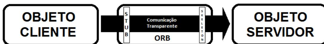
Figura 3.4 - Comunicação interna no ORB via interfaces.
