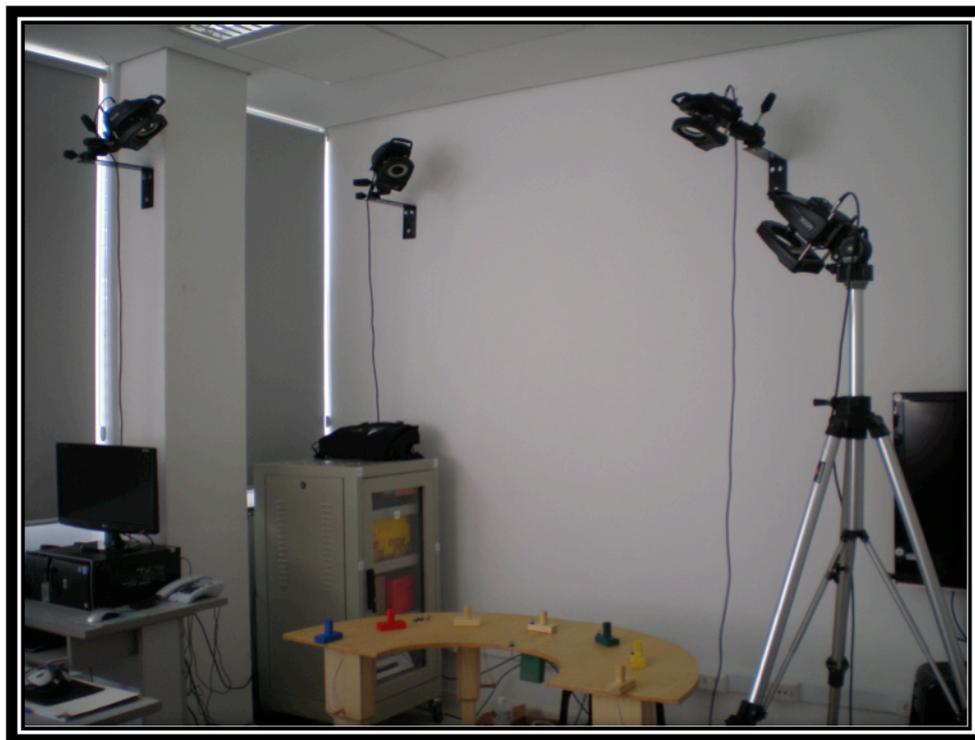
Figura 12. Ilustração do posicionamento das câmeras acopladas ao sistema Vicon.
