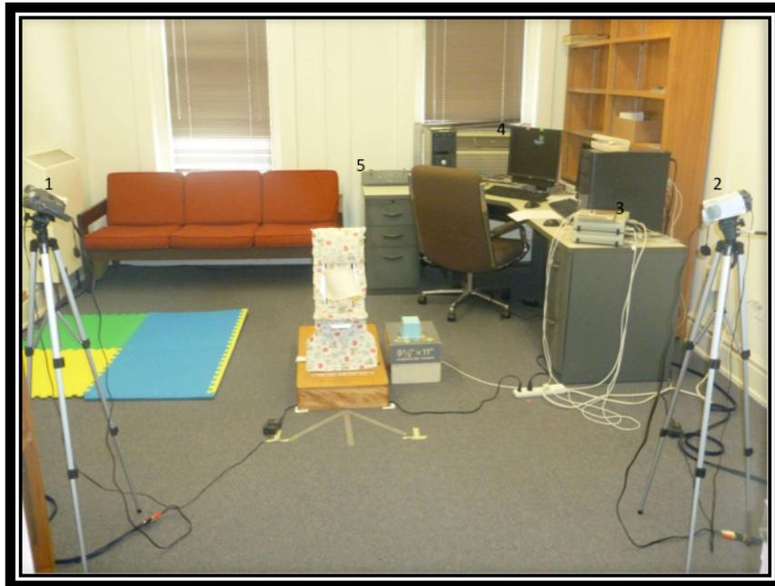
Figura 3. Ilustração do posicionamento das câmeras (1 e 2), sistema Flock of Birds (3), tela para captura online (4), e equipamento MX-4 DV (5).
