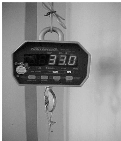
Figura 2. Balança industrial eletrônica para ponte rolante Challenger 2 MSI-3360 que foi acoplada ao mecanismo de sustentação de peso corporal .
