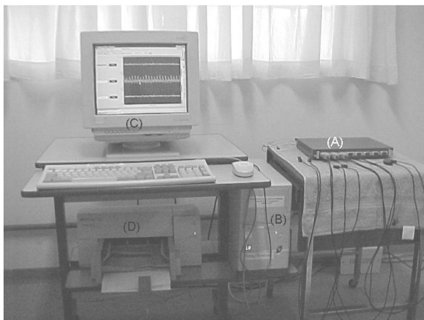
Figura 5. Ilustração do módulo MCS1000-V2 (A), microcomputador (B), monitor de vídeo (C) e impressora (D).
