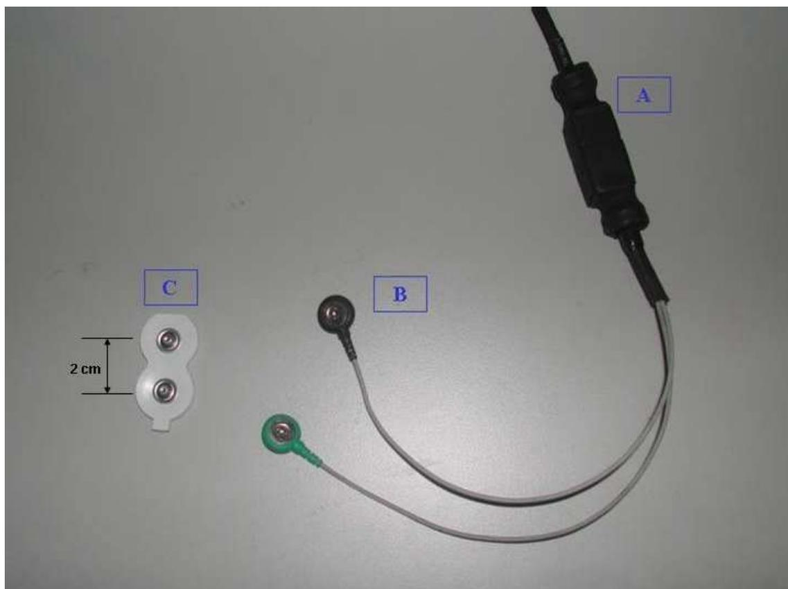
**Figura 7.** A: eletrodo bipolar diferencial ativo; B: terminais de acoplamento ao eletrodo de Ag/AgCl; C: eletrodos de superfície de Ag/AgCl.
