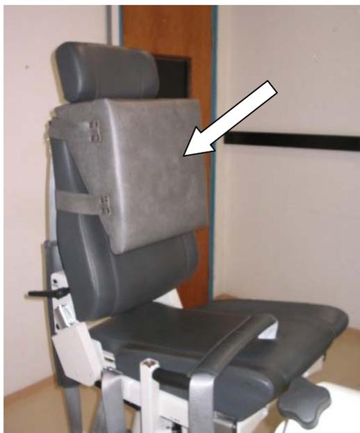
**Figura 3:** Acessório acolchoado acoplado ao encosto da cadeira do dinamômetro (seta)
