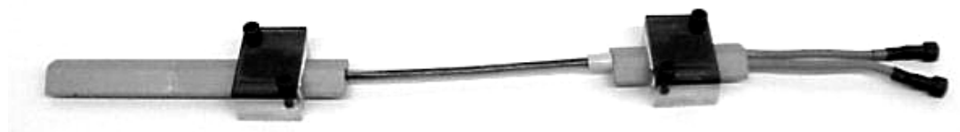
Figura 2 - Foto de um eletrogoniômetro dentro das Canaletas de Acoplamento.
