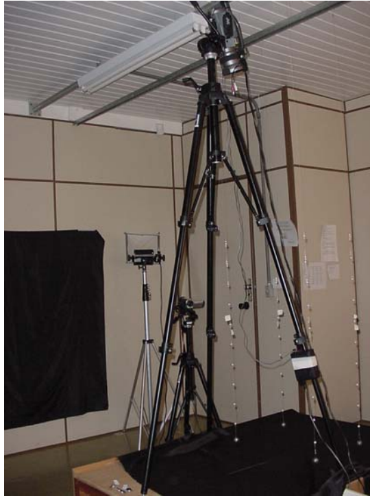
FIGURA 14A: Conformação das câmeras que registram a movimentação do membro superior esquerdo do lactente.
