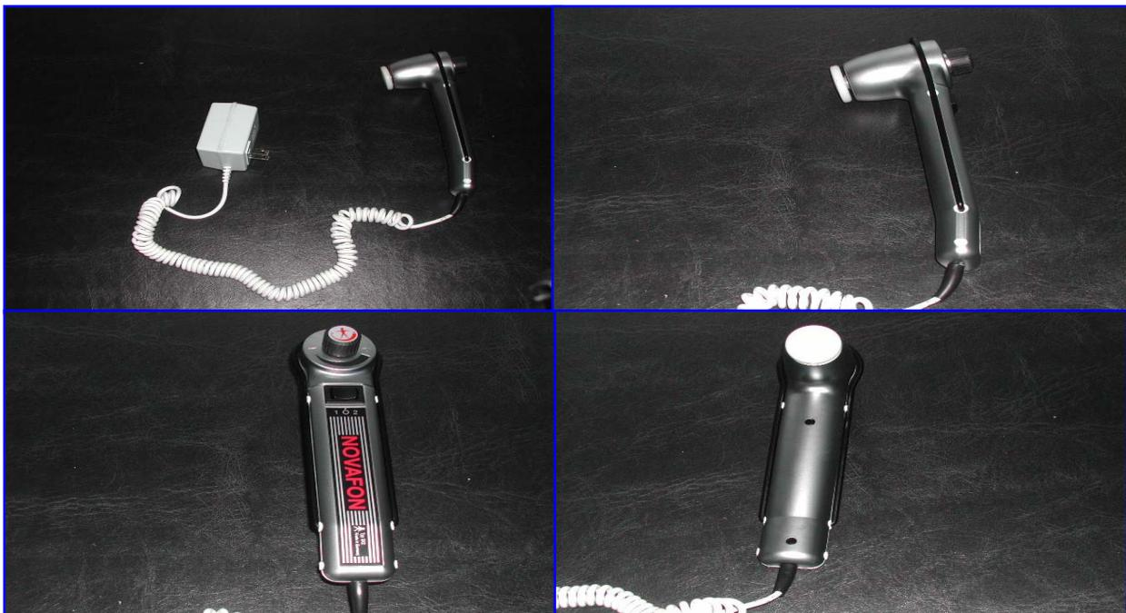
**Figura 1** – Equipamento gerador de estímulos vibratórios.
