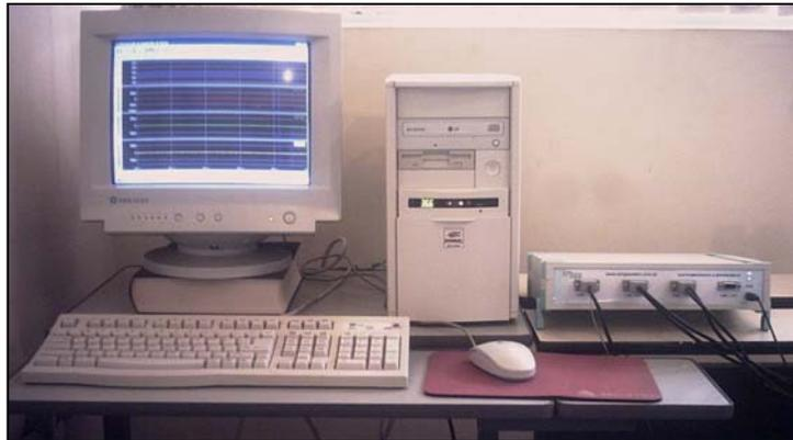
**Figura 1:** Eletromiógrafo EMG-8 (EMG System do Brasil) de 8 canais, conectado ao computador equipado com o *software* AqDados 7.02.06 (na tela).
