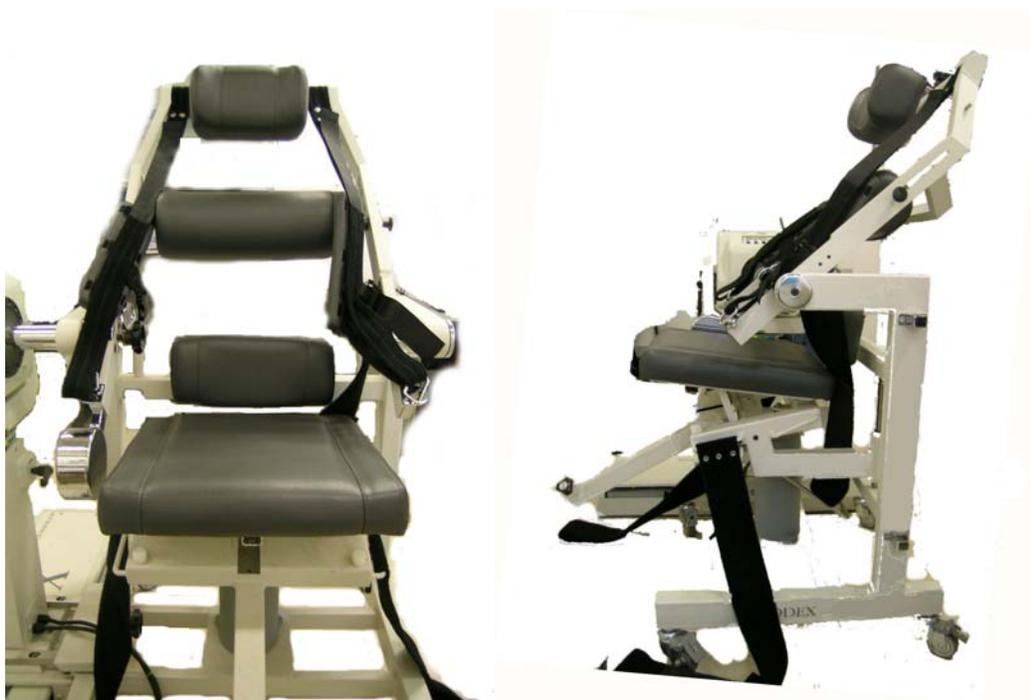
**Figura 1.** Cadeira especial para avaliação do tronco no equipamento Biodex Multi Joint System 3, nas vistas anterior e lateral.
