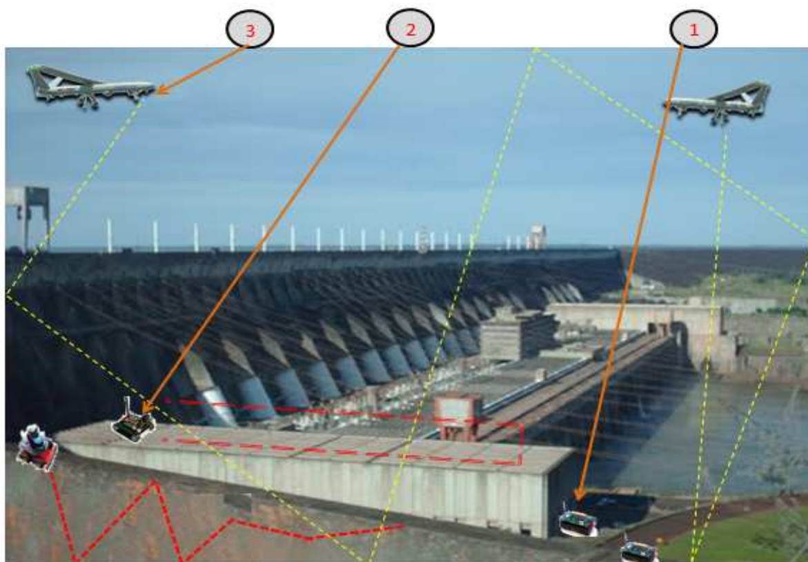
Figura 5.1- ilustração de aplicação de monitoramento de hidrelétrica por meio de rede heterogênea (nós fixos, VANT e robôs terrestres)
