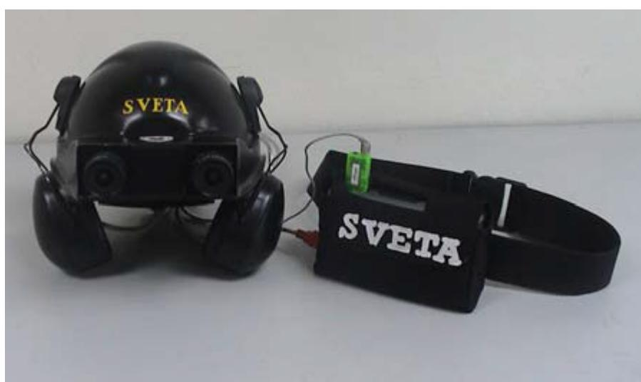
**Figura 4.9:** SVETA: Protótipo de auxílio a navegação de deficientes visuais (BALAKRISHNAN et al., 2007).
