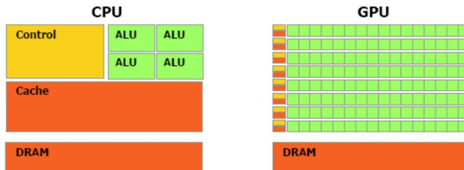
**Figura 2.5: Diferença entre as arquiteturas da CPU e GPU (JR et al., 2008).**
