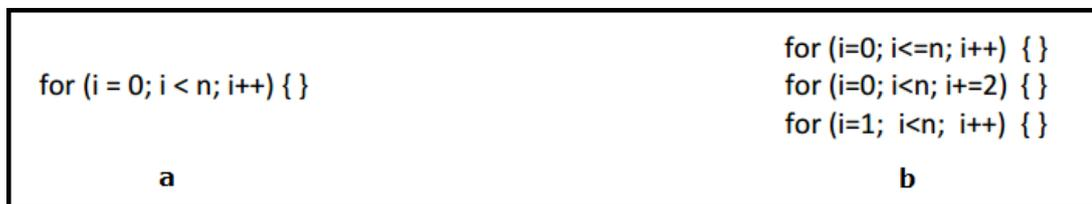
**Figura 3.5:** Ferramenta CHiMPS. (a) Exemplo de código C suportado. (b) Exemplo de código C não suportado (PUTNAM et al., 2008).
