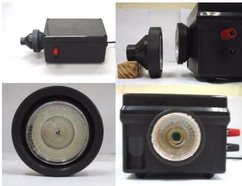
**Figura 2.4** – Fotos do módulo de detecção construído, empregando um fotodiodo de silício e a cela de medida de tubo de polietileno em espiral, para o monitoramento da radiação quimiluminescente.
