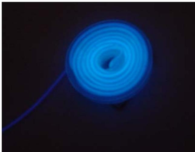
**Figura 2.8-** Fotografia mostrando emissão de luz da cela preenchida pelos reagentes empregados na determinação de  $\text{H}_2\text{O}_2$  por quimiluminescência
