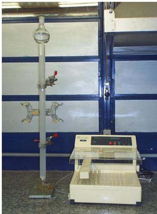
**Figura A5** – Sistema cromatográfico para purificação de enzimas, constituído de coletor de frações e coluna cromatográfica contendo gel Sephadex G-100.
