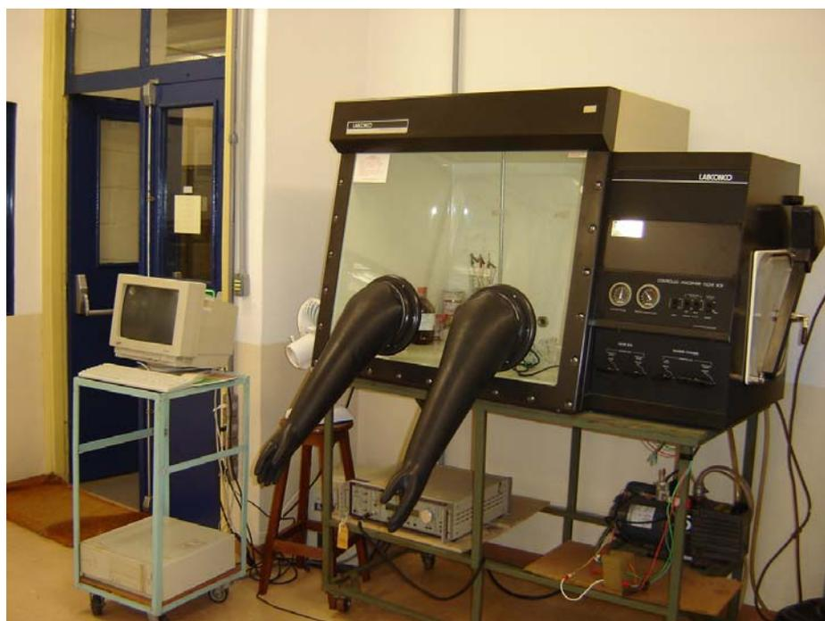
FIGURA 2.6: Câmara de atmosfera controlada utilizada para os experimentos de carga / descarga.
