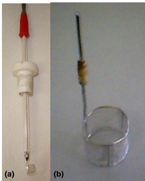
FIGURA 2.5: Eletrodos de platina utilizados como eletrodos auxiliares para deposição dos polímeros (a) e para os testes de Espectroscopia de Impedância Eletroquímica (b).
